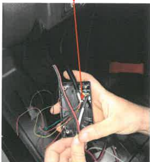
Conexiones caja adaptadora de señal
