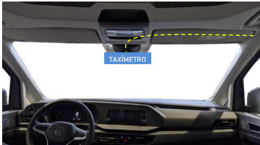
Figura 30. Trazado del cable del módulo tarifario
