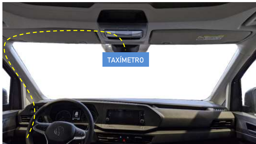
Figura 28. Recorrido de la manguera del taxímetro.
