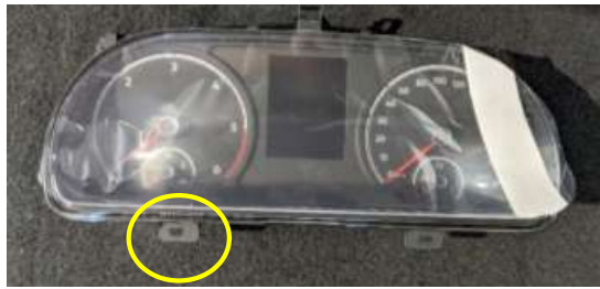
Figura 13. Ubicación tornillo a sustituir.
