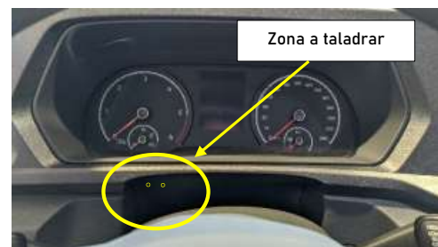
Figura 16. Detalle zona a taladrar.
