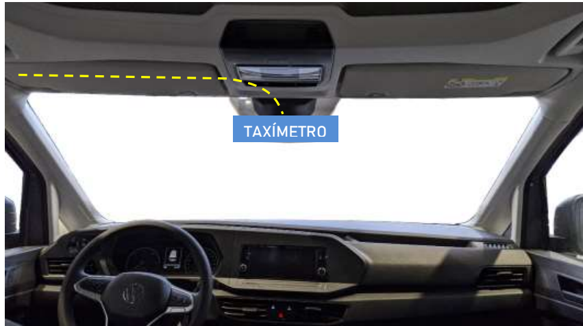
Figura 29. Trazado del cable del módulo tarifario
