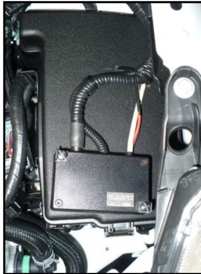
Ejemplo caja de señales fijada en caja de fusibles
