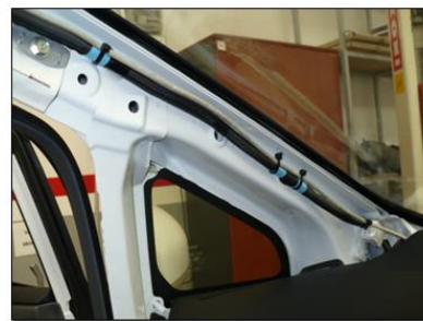
Recorrido del cable del módulo tarifario
