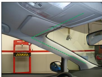
Recorrido del cable del módulo tarifario
