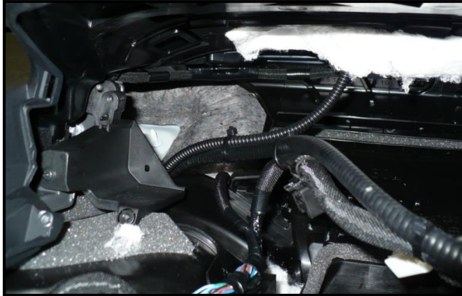
Cable baja por el lateral izquierdo del hueco de radio
