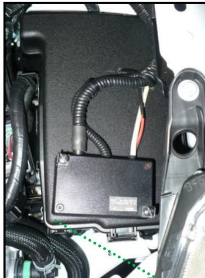
Caja de señales fijada en caja de fusibles
