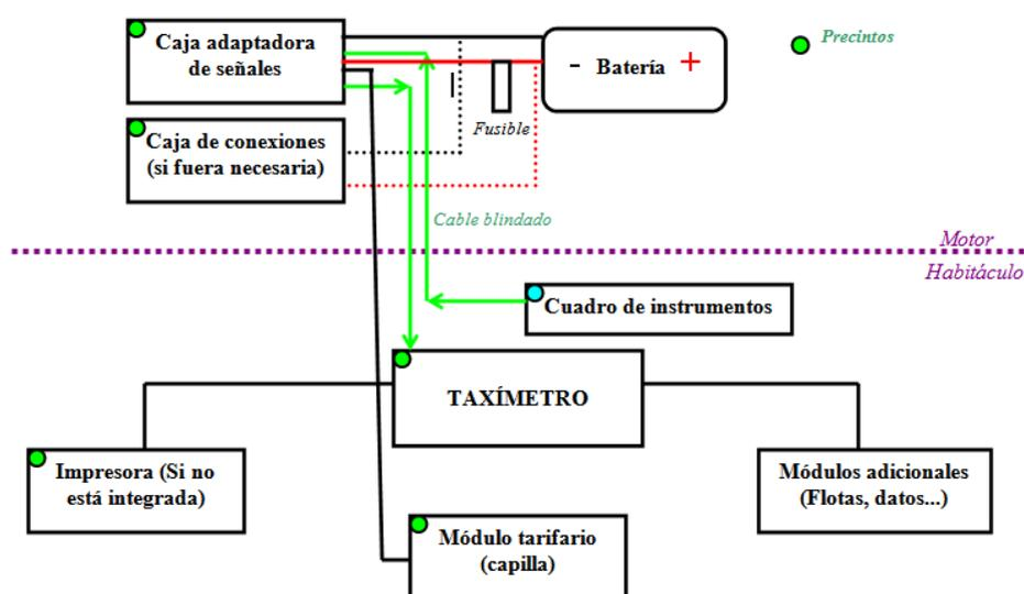
Se pueden producir diferencias en el esquema en función del aparato taxímetro instalado; si es un modelo integrado que abarca en el mismo aparato taxímetro, impresora, módulo de datos etc, los módulos pueden ser sustituidos por una centralita común que se conecte directamente al taxímetro.
