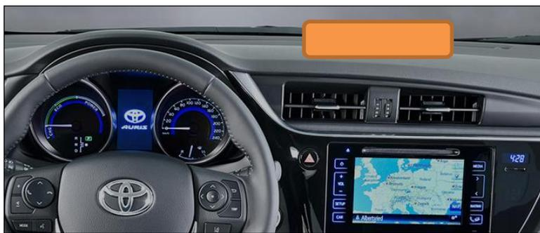
El soporte irá fijado con tornillos rosca-chapa y la distancia entre ambos variará en función del modelo de taxímetro.
