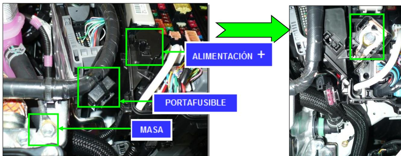
En caso de tener que montar caja de conexiones eléctricas (alimentación de taxímetro, capilla, etc), dicha caja irá instalada junto a la caja de señales (ubicada en la tapa de fusibles), fijada mediante tornillos y precintada.
