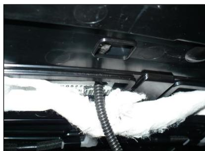
Para la ubicación de la impresora, en caso de no estar integrada en el propio taxímetro, se hace pasar la manguera correspondiente desde la bandeja superior central hacia la impresora. La impresora se puede sujetar mediante tornillos tipo rosca-chapa o mediante velcro.
