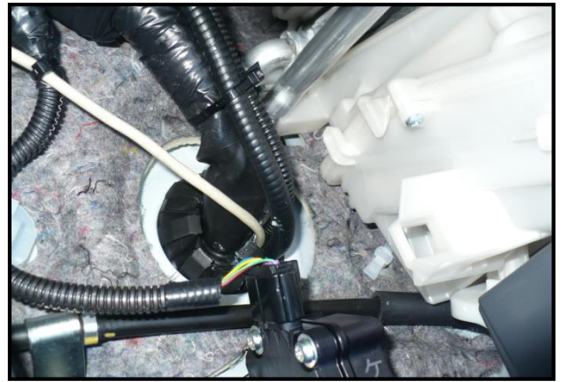
Pasar cables por el pasamuros, sobre el pedal del acelerador
