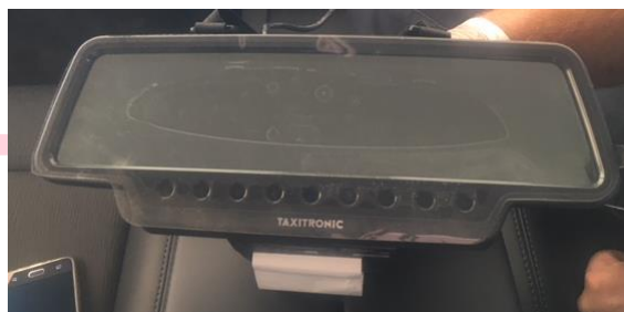
Ejemplo de taxímetro de espejo con impresora integrada
