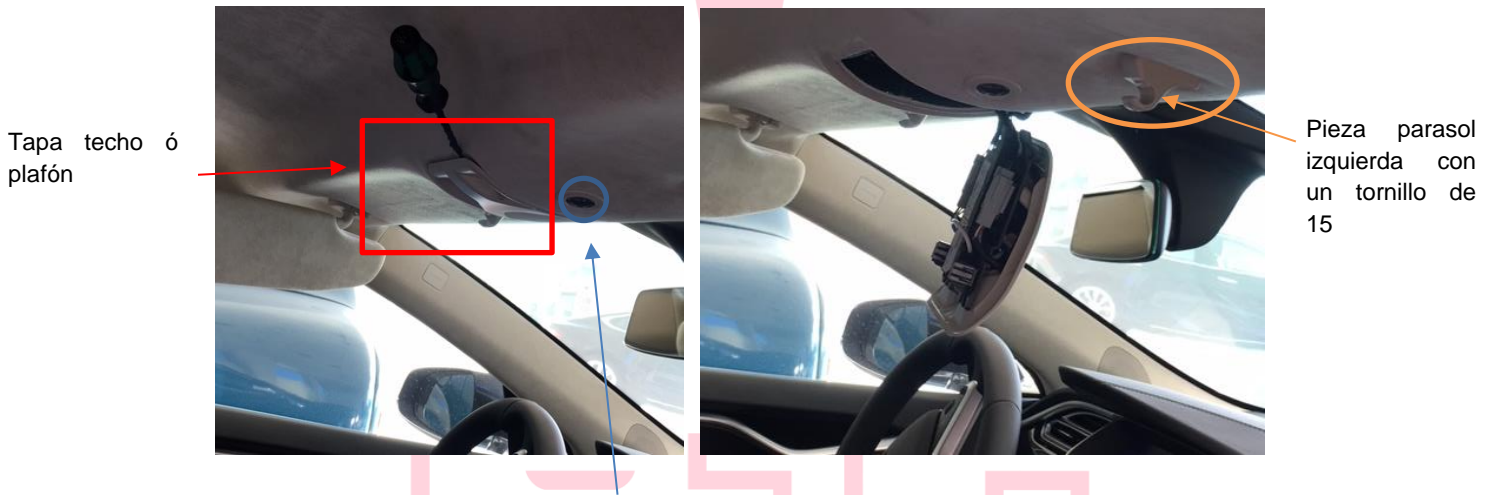
Tornillo de 15 (torx 15), lleva al otro lado otro tornillo de 15 (torx 15)
