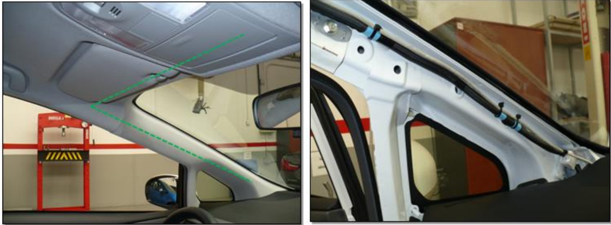
Recorrido del cable del módulo tarifario
