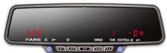
Taxímetro de espejo superpuesto al espejo original del vehículo. Éstos deben disponer y ser compatibles con impresoras periféricas.
