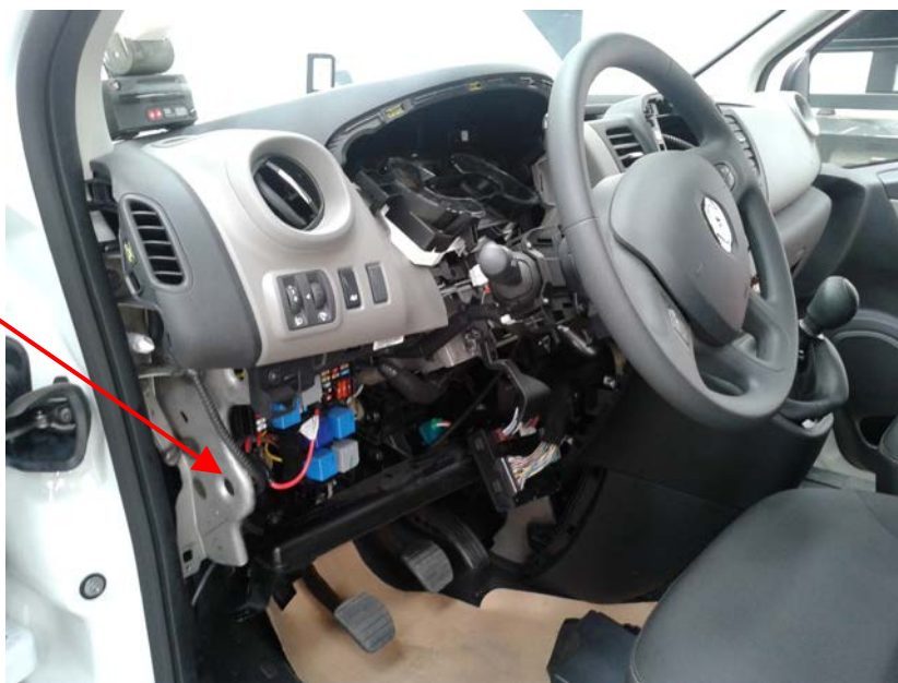
Fig. 1.4. Vista de la ubicación de la caja de fusibles
