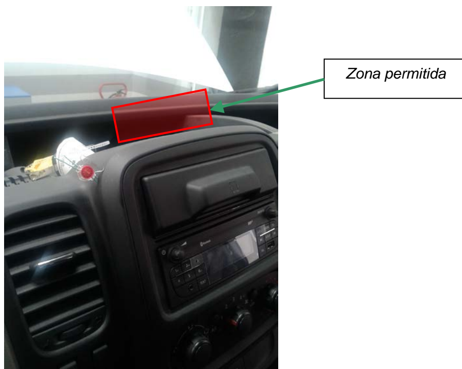
Fig. 5.1. Vista de la zona permitida para la instalación del taxímetro.
