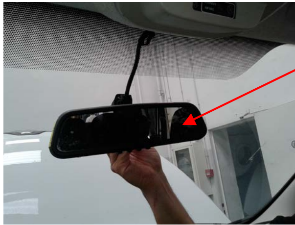
Fig. 9.1. Vistas de la disposición del taxímetro de espejo.
