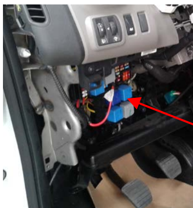
Fig. 4.1. Vista del paso de cable de señal por el salpicadero
