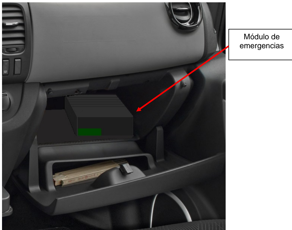
Fig. 11.1. Vista del emplazamiento del módulo de emergencias.
