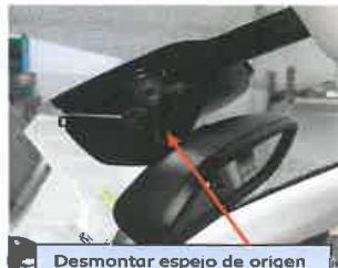
Desmontar espejo de origen
