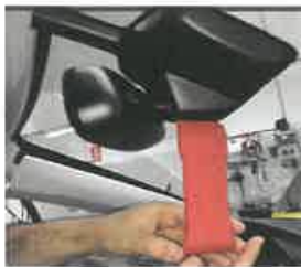
Desmontar espejo de origen
