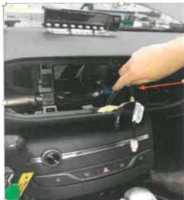
Guiar la manguera hasta el taxímetro
