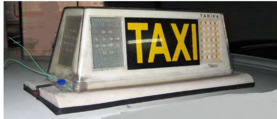
Fig. 6.3. Vista del módulo y su precinto
