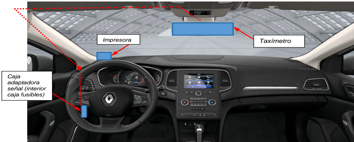
Fig. 4.4. Esquema orientativo de las conexiones.
