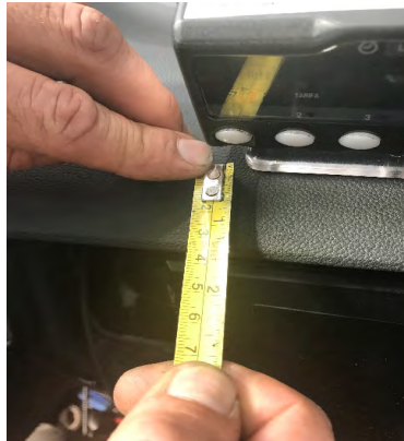
Fig. 5.2. Separación taxímetro a borde salpicadero.
