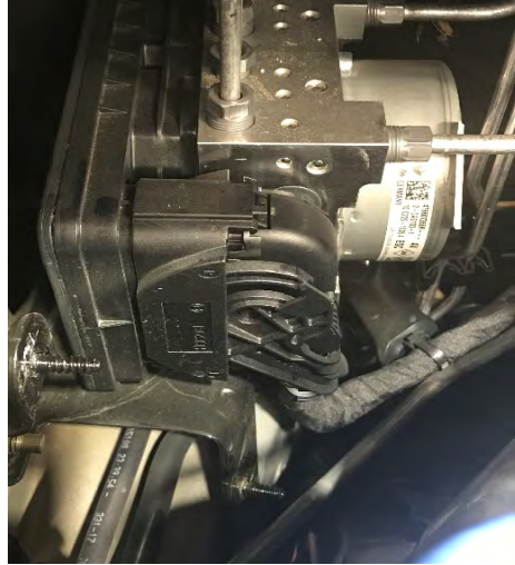
Fig. 1.3. Detalle conector 1094 módulo ABS/ESP
