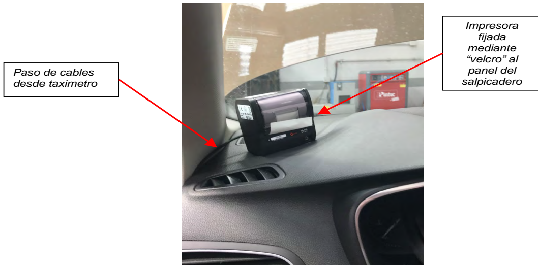
Fig. 5.6. Vistas de la disposición de la impresora.
