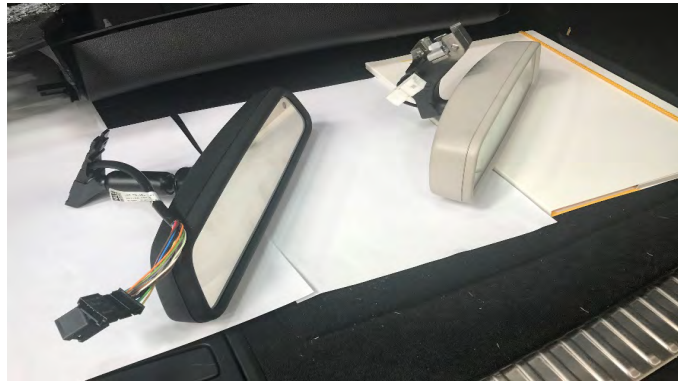
Fig. 5.3. Taxímetros de espejo y original del vehículo sustituido.
