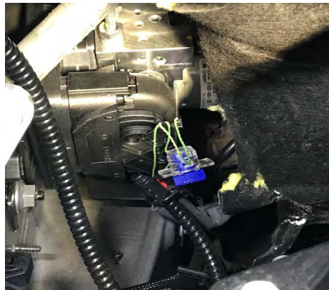
Fig. 1.6. Detalle del precintado del conector 1094 módulo ABS/ESP
