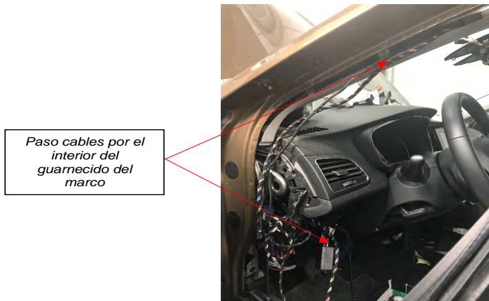
Fig. 4.5. Paso de cables para taxímetro de espejo.
