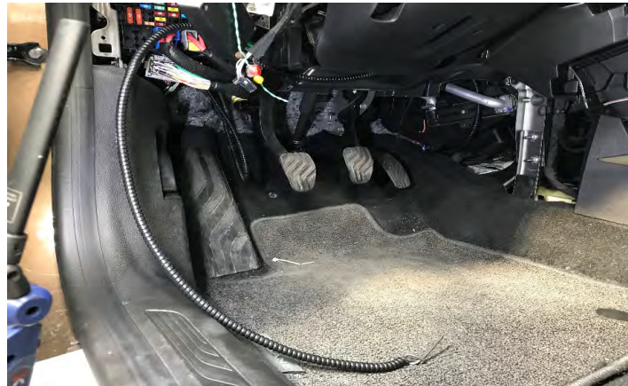
Fig. 3.1. Detalle paso cable de señal hasta el compartimento de la caja de fusibles
