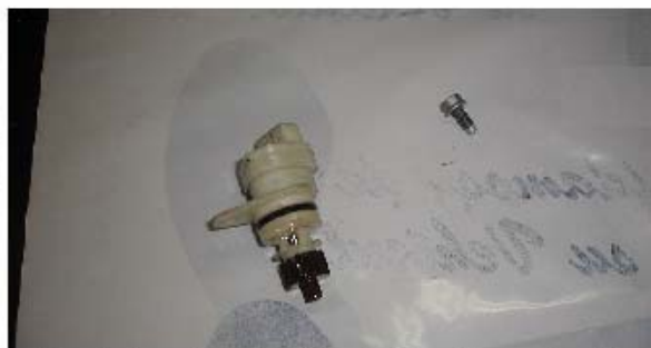
Captador de velocidad y tornillo sujeción
