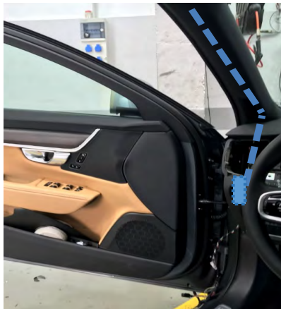
Fig. 4.6. Paso de cables para taxímetro de espejo.
