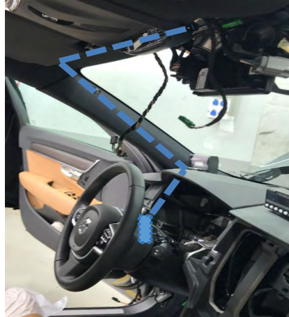
Fig. 4.7. Recorrido de los cables por el interior del guarnecido del techo.
