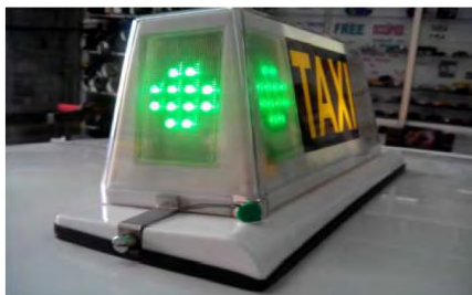
Fig. 6.3. Vista del módulo y su precinto
