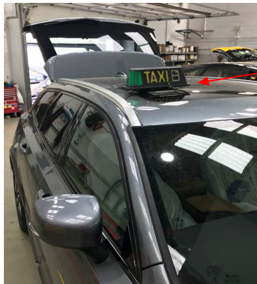
Fig. 6.4. Vista del módulo sobre soporte imantado
