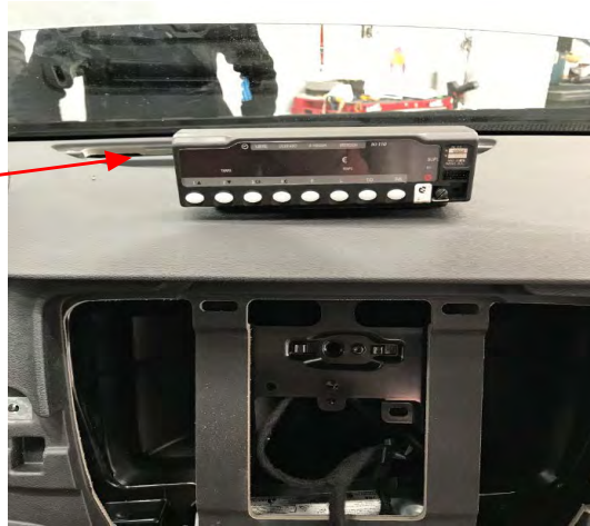
Fig. 5.2. Ejemplo de ubicación de taxímetro sobre salpicadero
