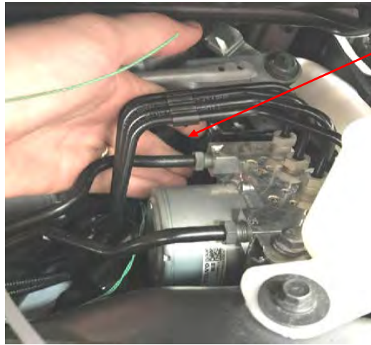
Fig. 2.1. Detalle de la toma de la conexión del cable de señal en el conector del VDDM
