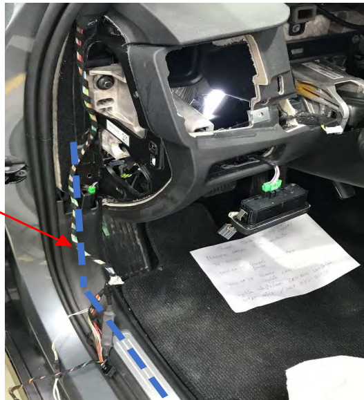
Fig. 3.4. Detalle paso cable de alimentación, vista habitáculo
