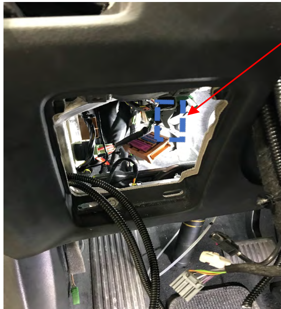
Fig. 3.1. Detalle paso cable de señal hasta el compartimento de la caja de fusibles
