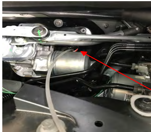
Fig. 3.2. Detalle del paso de cables al habitáculo
