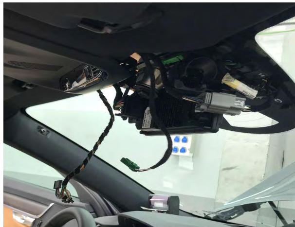
Fig. 5.5. Soporte para el taxímetro de espejo.
