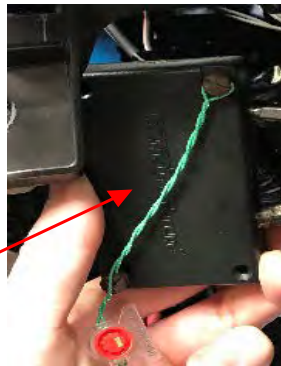
Fig. 3.3. Vista del compartimento de fusibles con la caja adaptadora de señal y detalle del precinto
