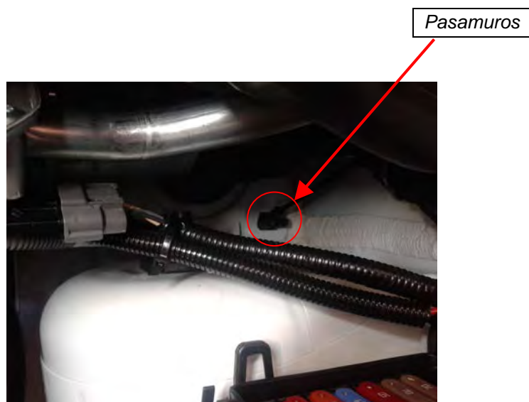
Fig. 1.3. Vista de la ubicación del pasamuros.
