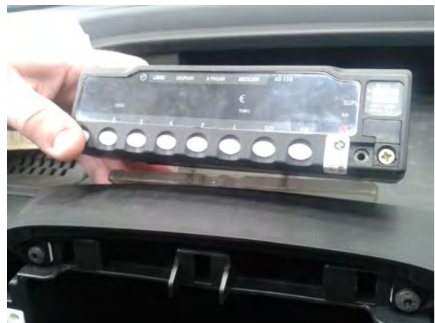
Fig. 6.1. Detalles de la sujeción del soporte y del taxímetro.
