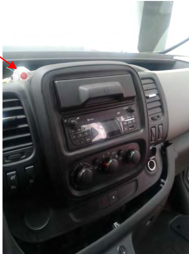
Fig. 3.1. Vista de la disposición del precintado de la consola central por parte de la marca
