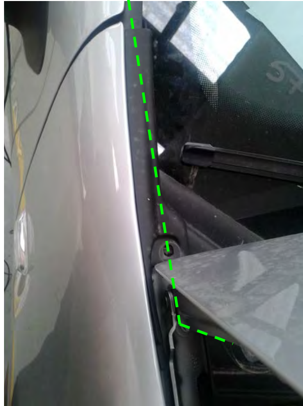
Fig. 9.4. Vista del paso de la manguera al compartimento motor
