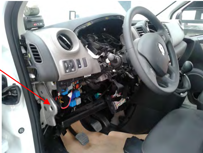
Fig. 1.4. Vista de la ubicación de la caja de fusibles
