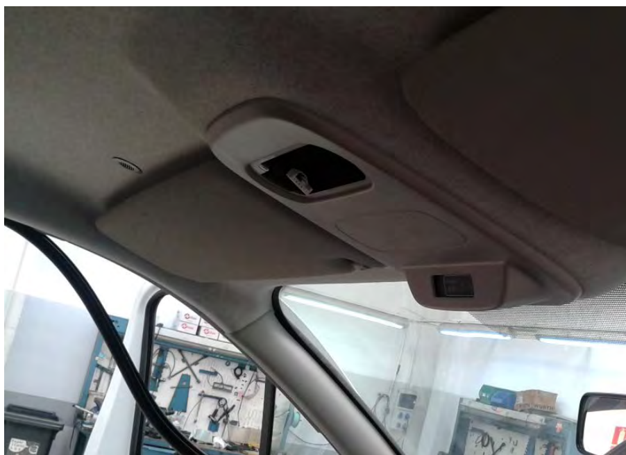
Fig. 9.1. Vista del acceso al techo por el plafón superior.
