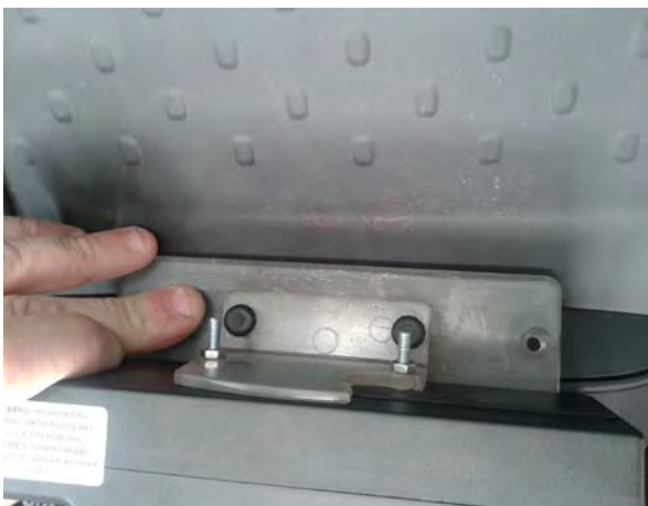
Fig. 6.1. Detalles de la sujeción del soporte y del taxímetro.
