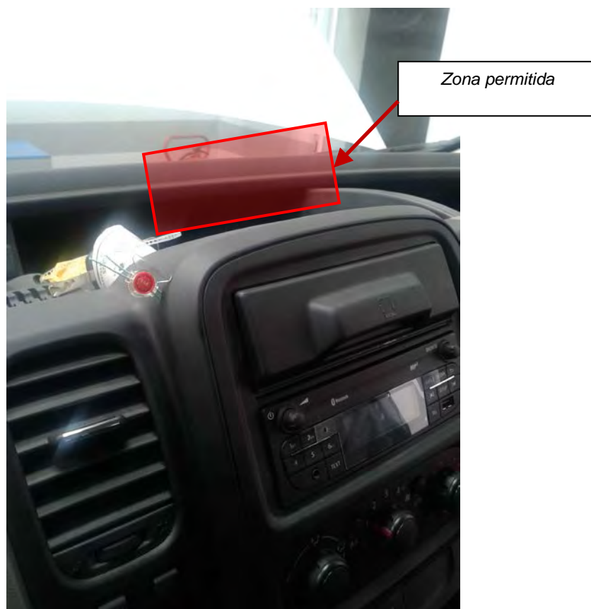
Fig. 5.1. Vista de la zona permitida para la instalación del taxímetro de consola
