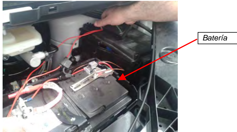
Fig. 1.2. Vista del alojamiento motor. Ubicación de la batería.
