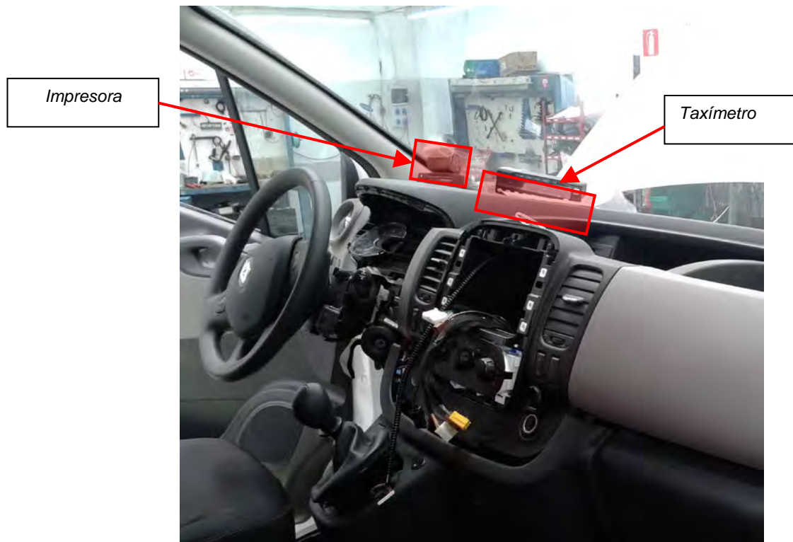
Fig. 5.2. Vistas de la ubicación del taxímetro de consola y de la impresora
