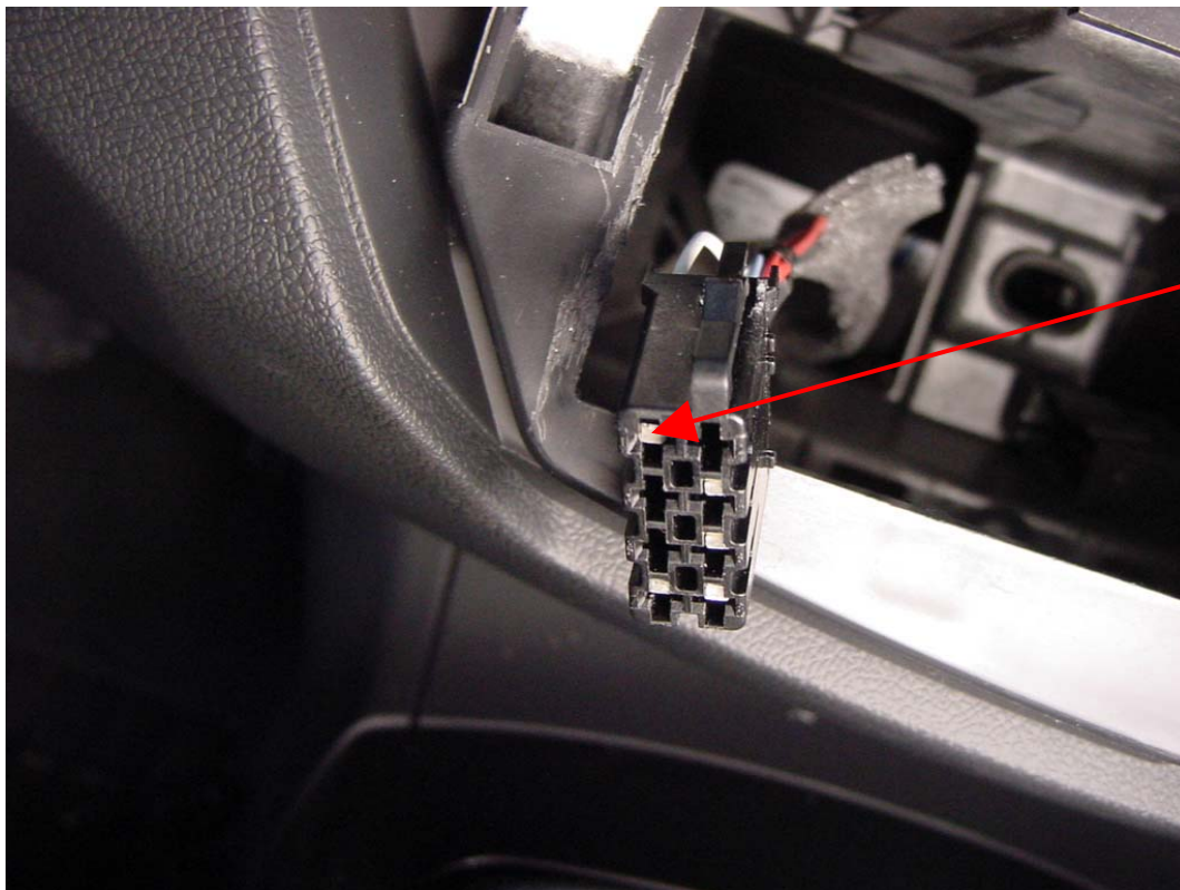
Fig. 2.1. Vista frontal del conector extraído. La señal se obtendrá de la parte trasera. El cable verde de señal se soldará en el pin 1.
