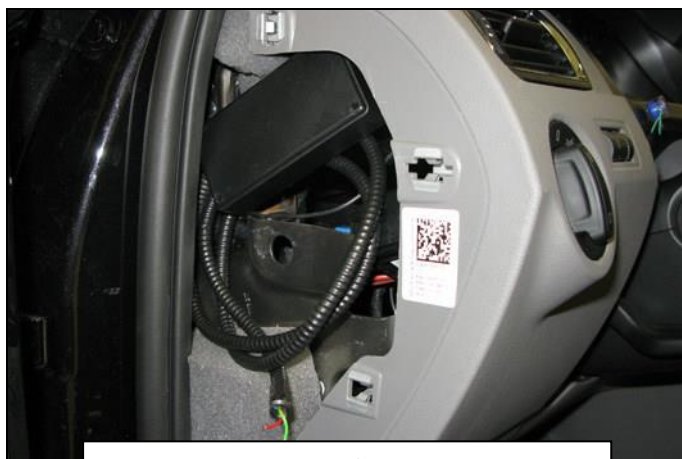
Manguera de señal de velocidad
