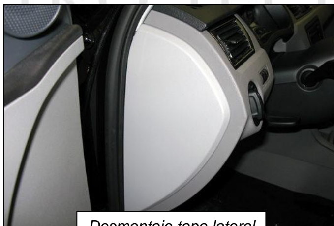
Desmontaje tapa lateral
