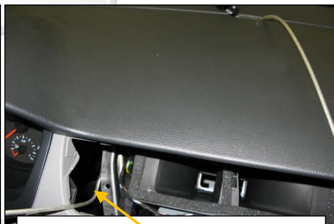
Pasar el cable por la parte izquierda del alojamiento del difusor de aire central
