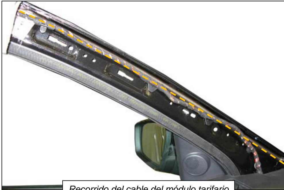
Recorrido del cable del módulo tarifario
