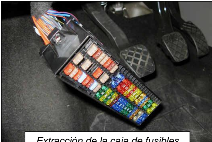
Extracción de la caja de fusibles
