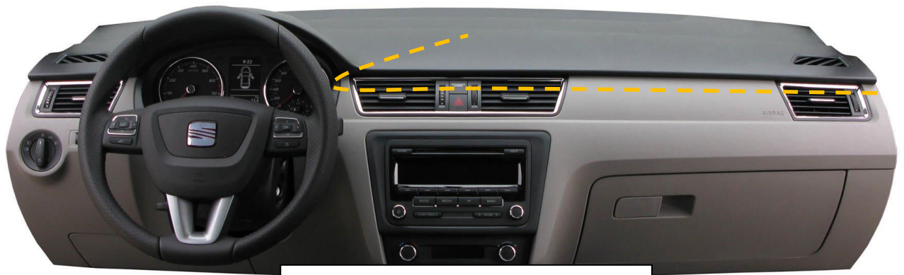
Trazado del cable módulo tarifario
