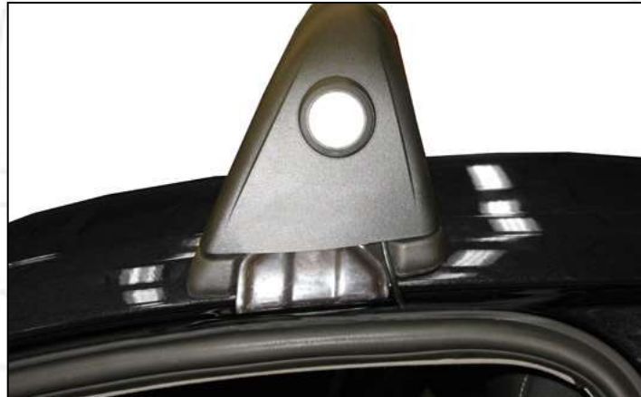
Emplazamiento y paso del cable del módulo tarifario
