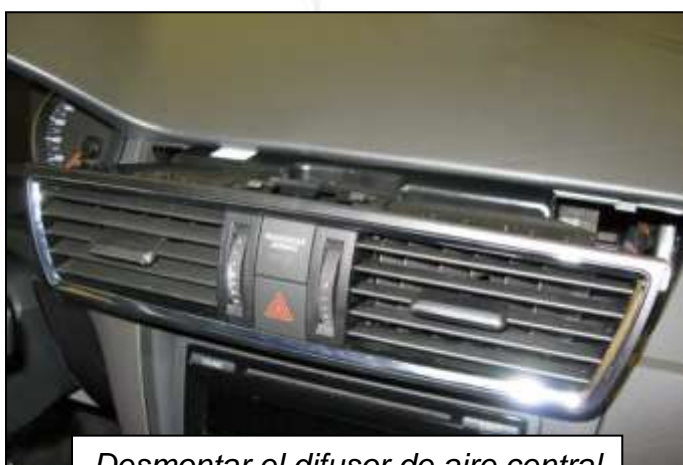
Desmontar el difusor de aire central
