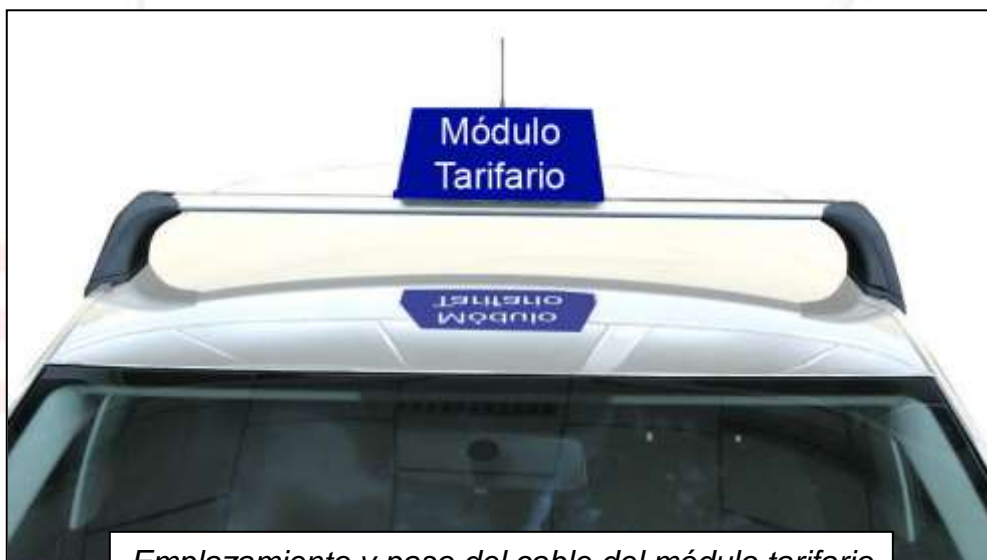
Emplazamiento y paso del cable del módulo tarifario
