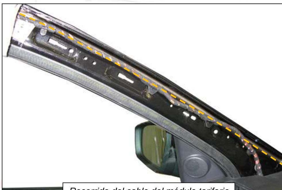
Recorrido del cable del módulo tarifario
