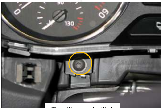
Tornillo a substituir
