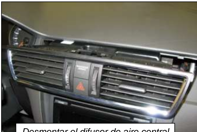
Desmontar el difusor de aire central
