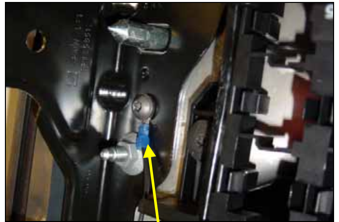
Cable de masa conectado
