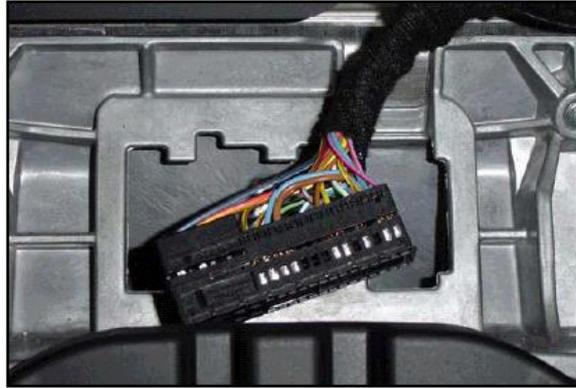
Se conecta la manguera blindada del aparato taxímetro con el sensor de velocidad con el pin 28 o el pin 9, según sea el caso, del conector del cuadro de instrumentos.
