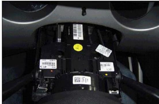
Se retira el embellecedor del cuadro de instrumentos (dos tornillos laterales).
