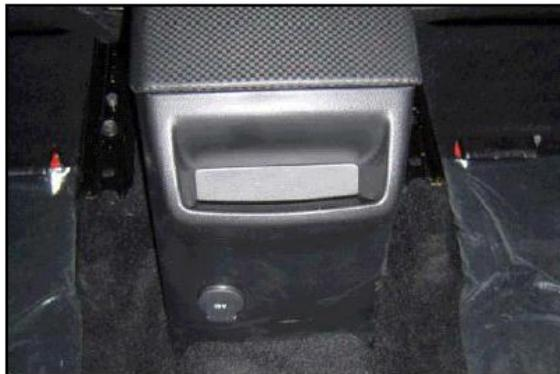
Se retiran los dos tornillos que se encuentran por debajo de la tapa posterior de la consola central.
