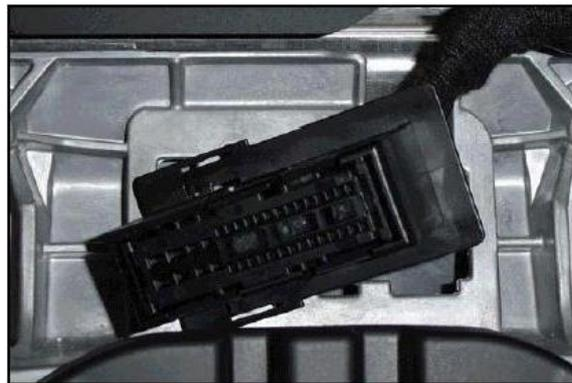
Se retira la primera tapa de plástico del conector del cuadro de instrumentos.
