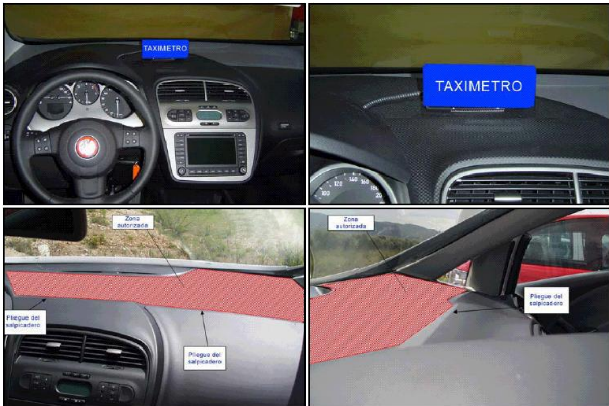
Zona autorizada para el montaje del taxímetro
