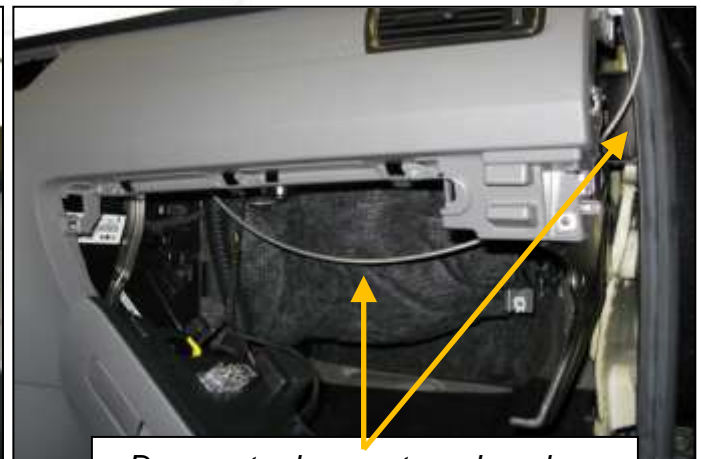
Desmontar la guantera derecha y pasar el cable por detrás hacia el montante A derecho
