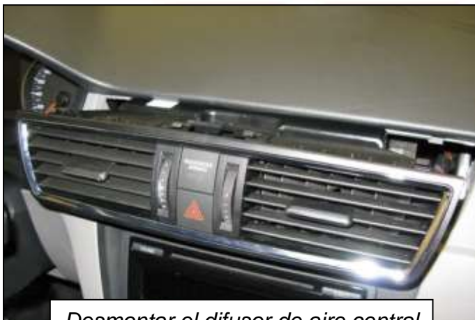
Desmontar el difusor de aire central
