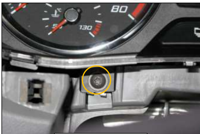
Tornillo a substituir
