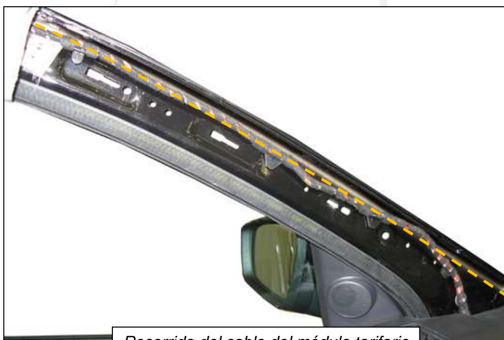
Recorrido del cable del módulo tarifario
