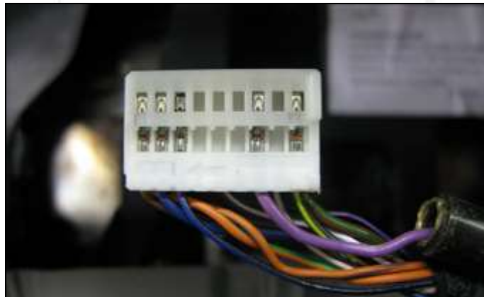
Conexión de la señal taquimétrica en el pin nº 3
