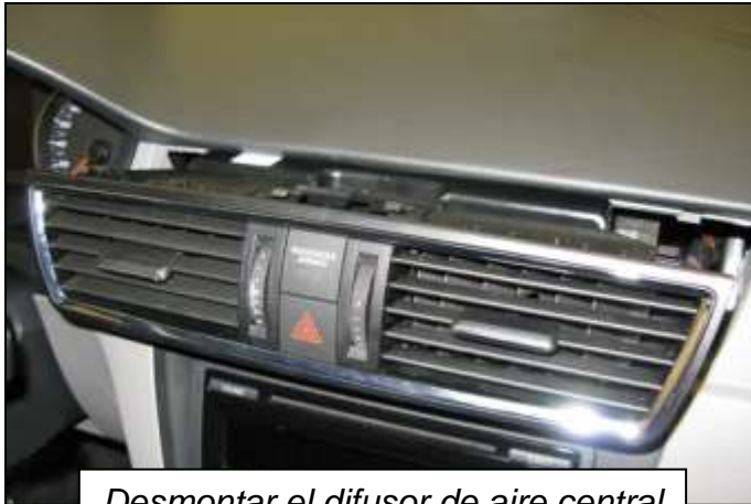
Desmontar el difusor de aire central
