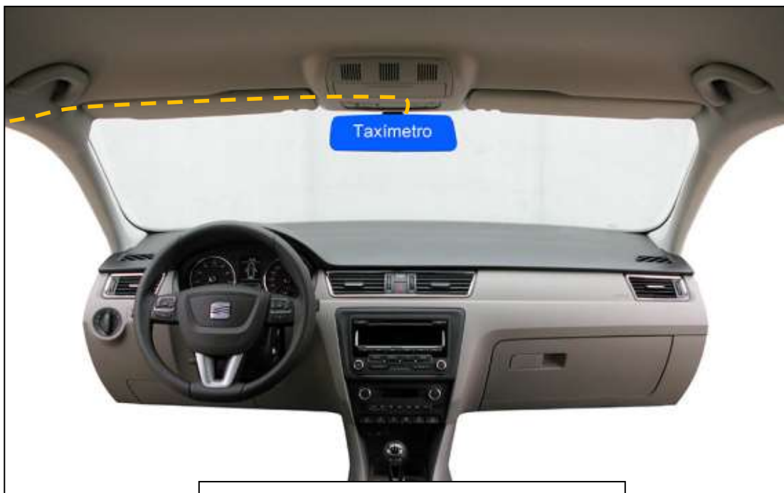
Trazado del cable del módulo tarifario
