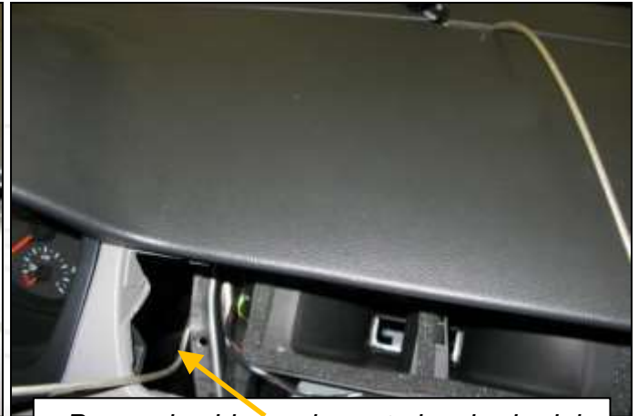
Pasar el cable por la parte izquierda del alojamiento del difusor de aire central
