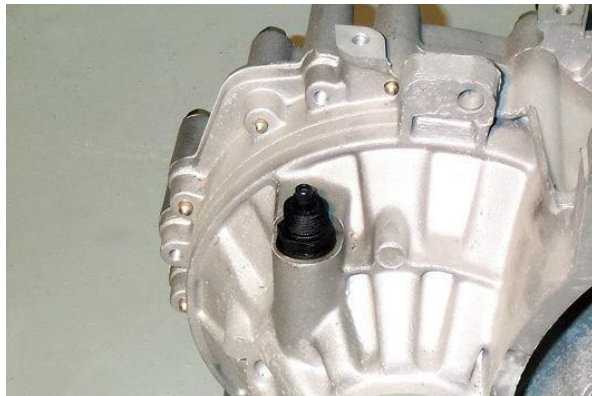
Parte inferior sensor de velocidad montada
