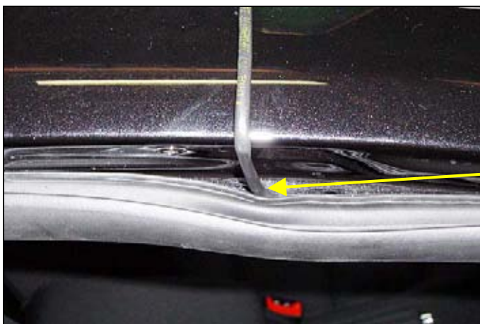
Paso del cable del modulo por debajo de la goma de estanqueidad de la puerta
