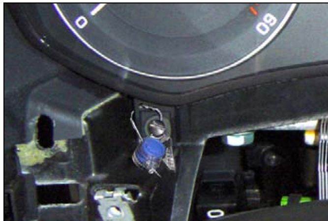
Precinto montado en cuadro de instrumentos
