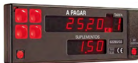
Ejemplo de taxímetro de tablero simple
