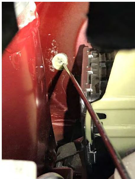
Fig. 2.2. Detalle pasamuros junto al módulo ABS/ESP
