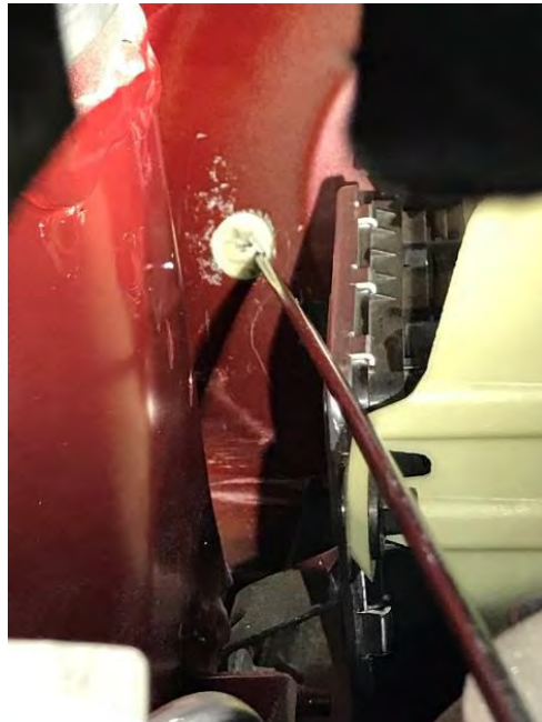
Fig. 2.3. Detalle pasamuros junto al módulo ABS/ESP
