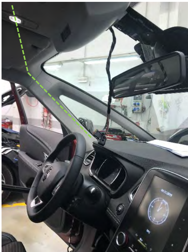
Fig. 6.2. Vista recorrido del cableado entre el módulo y la caja adaptadora de señal
