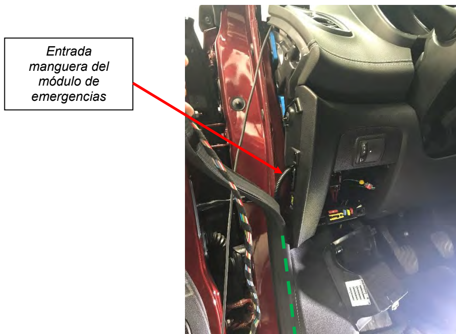
Fig. 7.2. Recorrido de la conexión módulo de emergencias.
