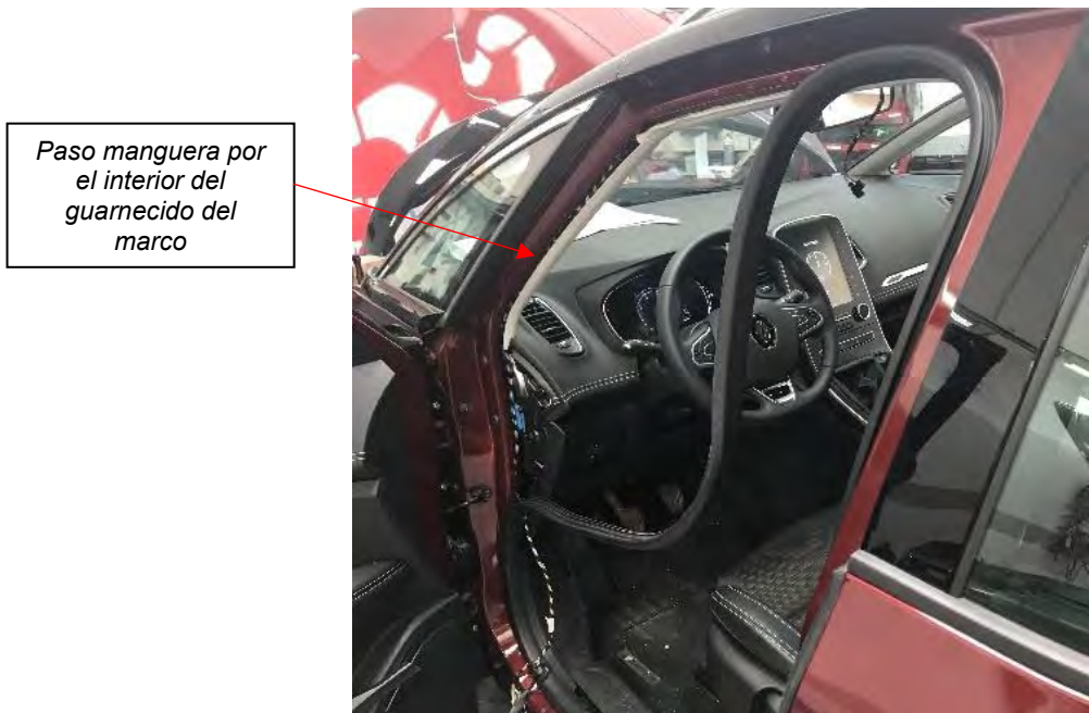
Fig. 4.1.2. Paso de cables por el interior del marco.
