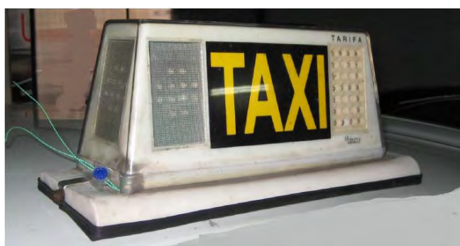
Fig. 6.3. Vista del módulo y su precinto
