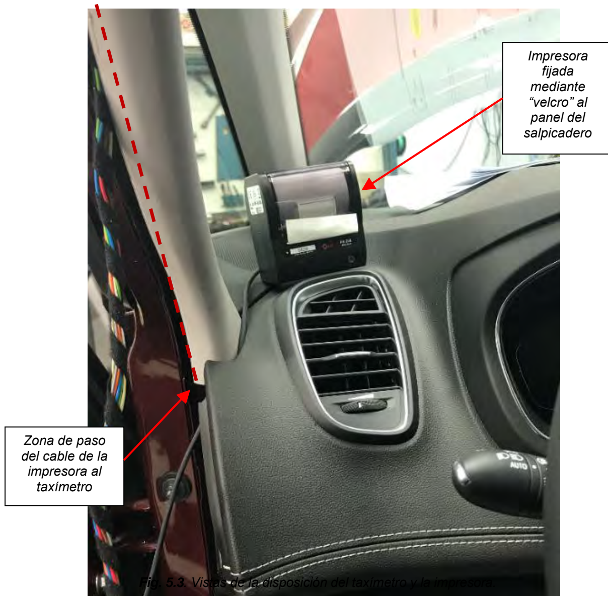
Fig. 5.3. Emplazamiento y conexionado de la impresora.
