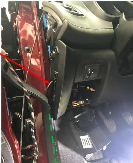
Fig. 7.2. Recorrido de la conexión módulo de emergencias.
