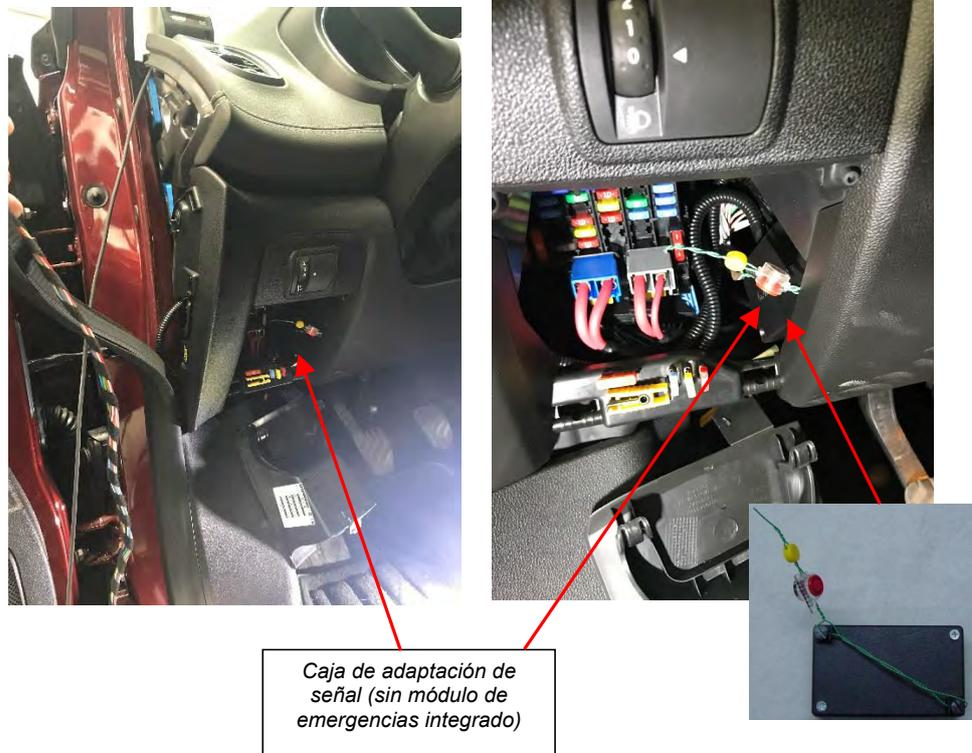
**Fig. 3.1 y 3.2.** Vistas del compartimento de fusibles con la caja adaptadora de señal y detalle del precinto.
