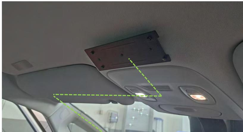
**Fig. 4.2.2.** Recorrido cableado y ubicación de soporte para taxímetro de techo.
