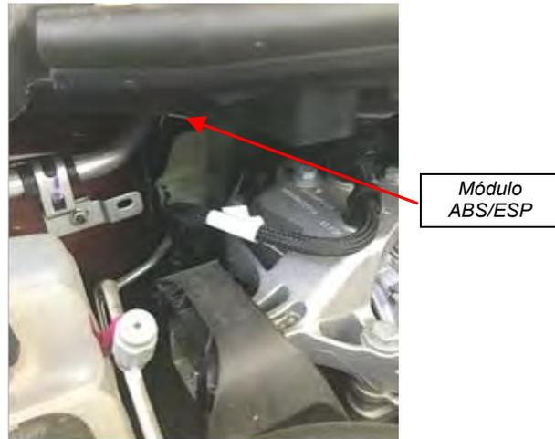
*Fig. 1.1. Vista de la ubicación del módulo ABS/ESP en el compartimento motor*
