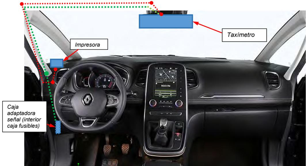
Fig. 4.1.1. Esquema orientativo de las conexiones.
