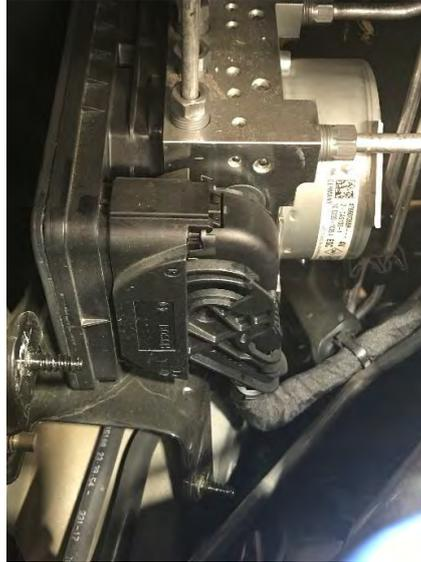
*Fig. 1.3. Detalle conector 1094 módulo ABS/ESP*
