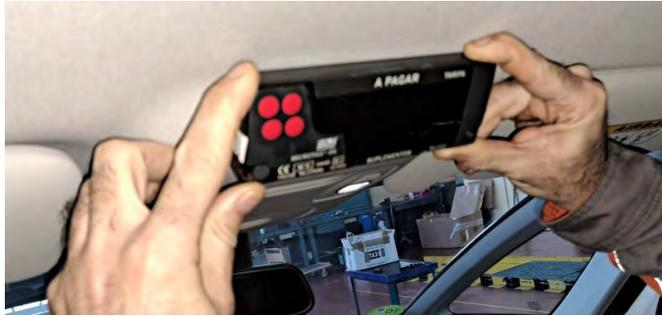
**Fig. 4.2.3.** *Taxímetro de consola simple de techo instalado.*
