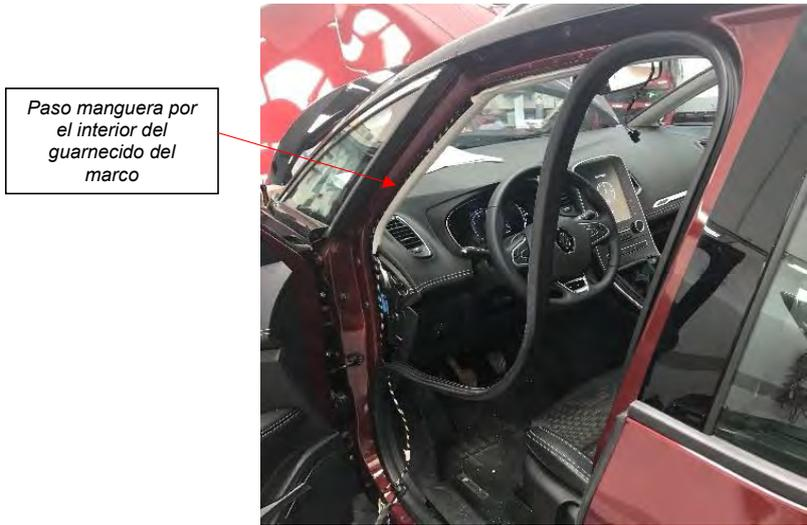
**Fig. 4.1.2.** Paso de cables por el interior del marco.
