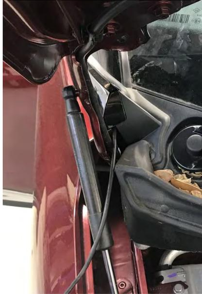
*Fig. 6.5. Vista del paso de cable del módulo al compartimento motor*
