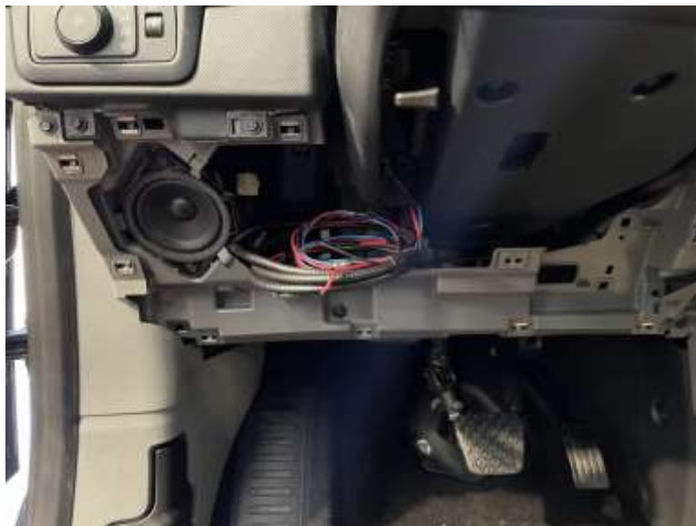
Localización de los cables para la posterior instalación de taxímetro
