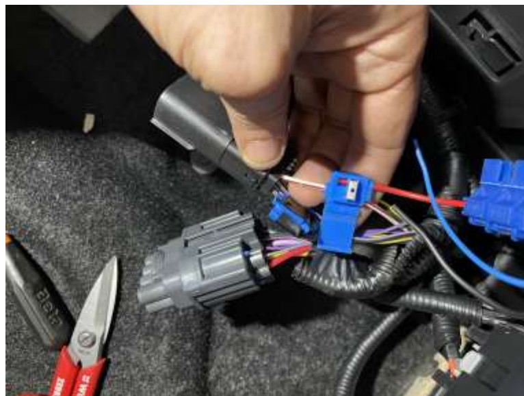
Desdoblamiento del cable
