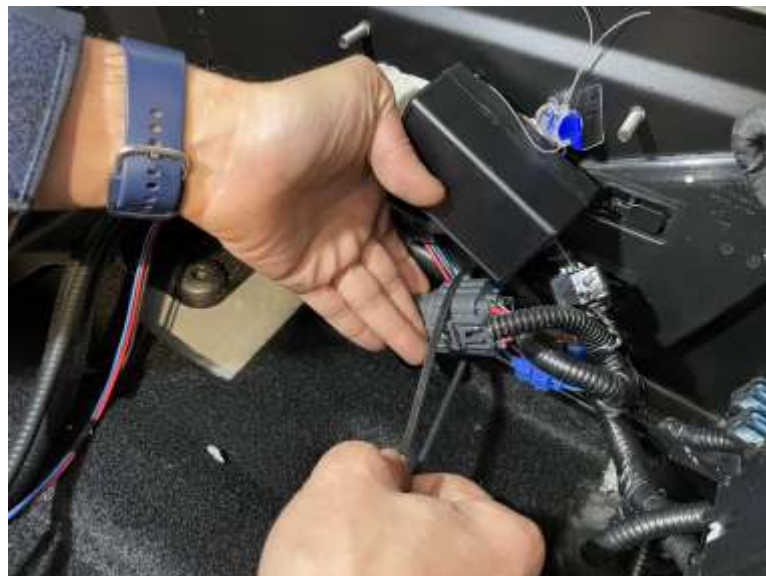
Fijación de la caja al lateral mediante bridas
