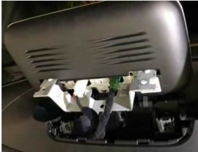
Desatornillamos los dos tornillos de torx para desmontar el marco del cuadro de instrumentos del salpicadero
