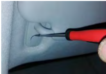
Desmontaje de parasol y Plafón
