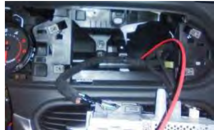
Extraemos el aparato de radio e introducimos la guia hacia abajo para llegar a la centralita Body Computer y subir el cableado para el taximetro, luminoso, impresora, gesti3n de flotas, 112 etc...
