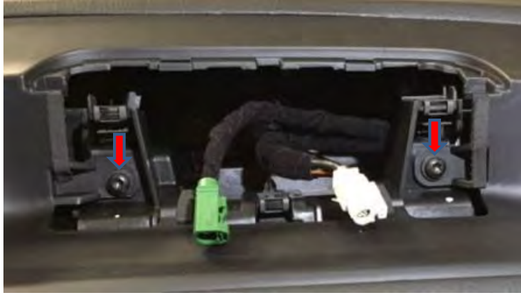
Soltamos las grapas del guardapolvos superior del volante
