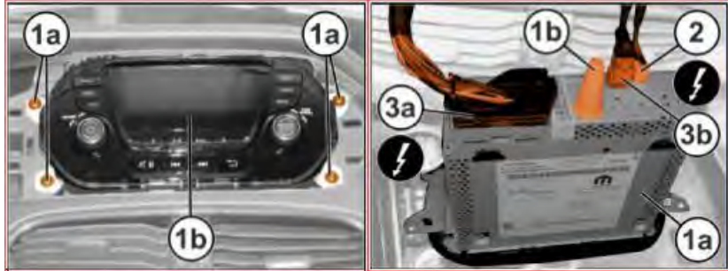
Desconectar la conexi3n de Antena y conexiones el3ctricas (3a y 3b)
