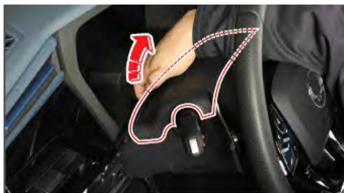
Fig. 1.2. Detalle extracción guarnecido superior del volante.
