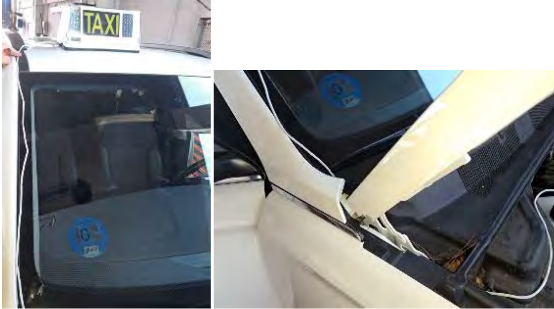
Fig. 6.2.4. Recorrido de los cables por vierteaguas del pilar A derecho.
