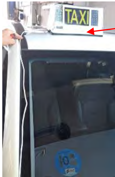
Fig. 6.2.1. Vista del módulo sobre soporte imantado
