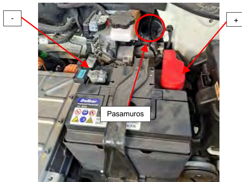
Fig. 4.1. Disposición de bornes de batería y pasamuros.
