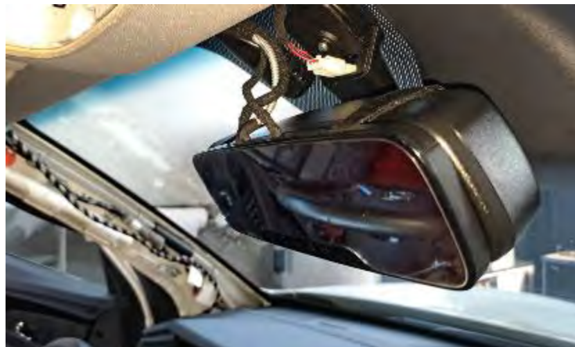
Fig. 4.2.3. Taxímetro de espejo superpuesto instalado.
