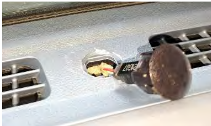
Fig. 4.1.3. Tapón extraído para paso de manguera blindada.
