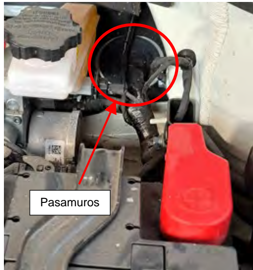
Fig. 2.1. Detalle pasamuros desde compartimento motor.
