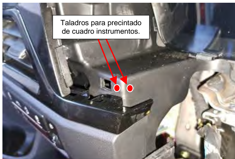
Fig. 3.1. Taladros precintado cuadro de instrumentos.
