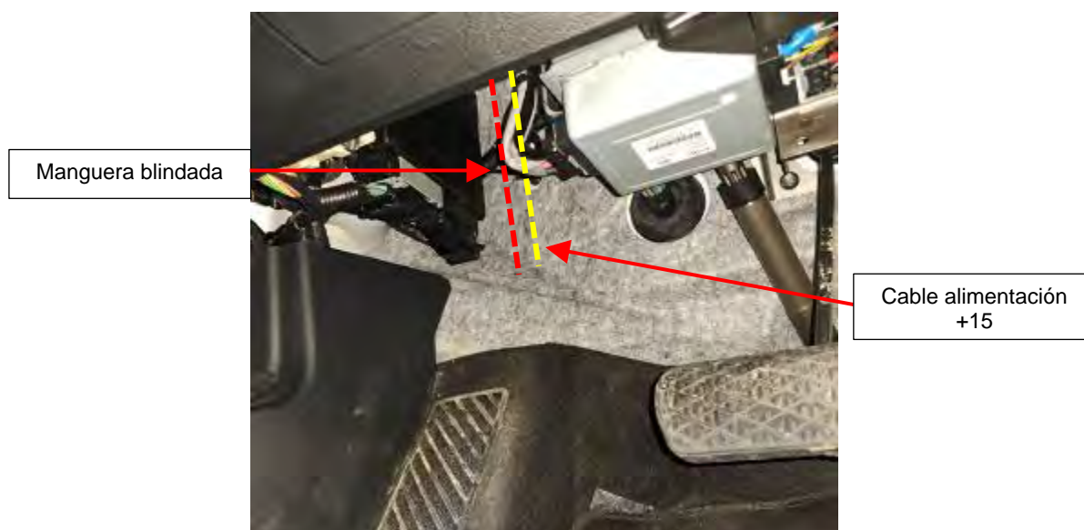
Fig. 4.2. Zona donde se dejará el cable de alimentación bajo llave +15.
