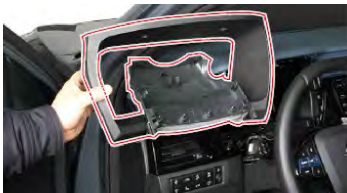
Fig. 1.3. Detalle extracción marco cuadro de instrumentos.
