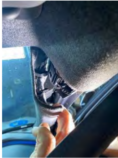
Fig. 5.5.1.8. Detalle de las grapas del pilar A
