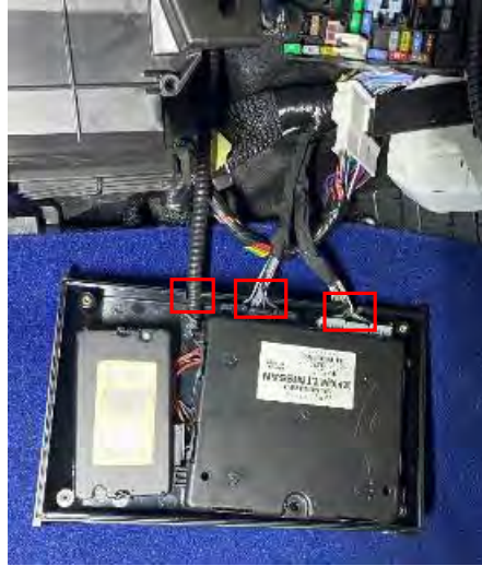
Fig. 3.4.1.2.3. Detalle rebajes en la caja contenedora
