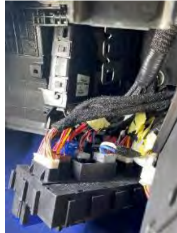
Fig. 3.4.1.9. Conjunto del soporte de fusibles.
