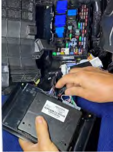
Fig.3.4.1.2.1. Caja contenedora de calculador de Climatización (órgano 419).
