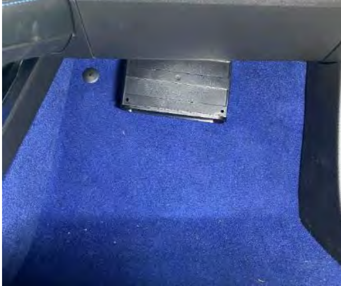
Fig. 3.4.1.2.6. Detalle emplazamiento caja contenedora precintada e instalada con velcro.
