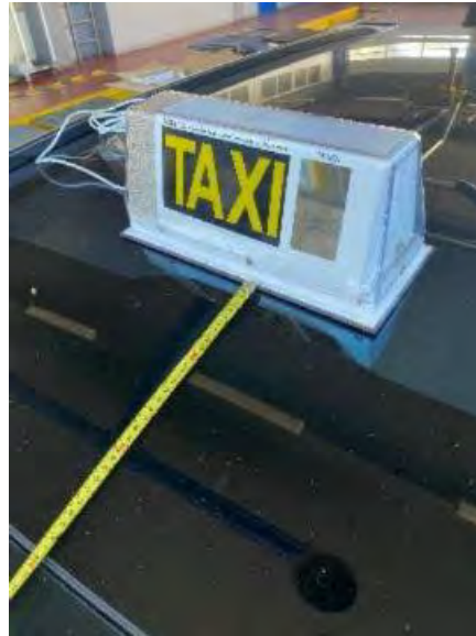
Fig. 5.5.1.2. Distancia de separación al parabrisas.
