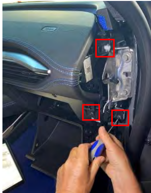
Fig. 3.4.1.6. Detalle tornillos y topes de sujeción de la guantera.
