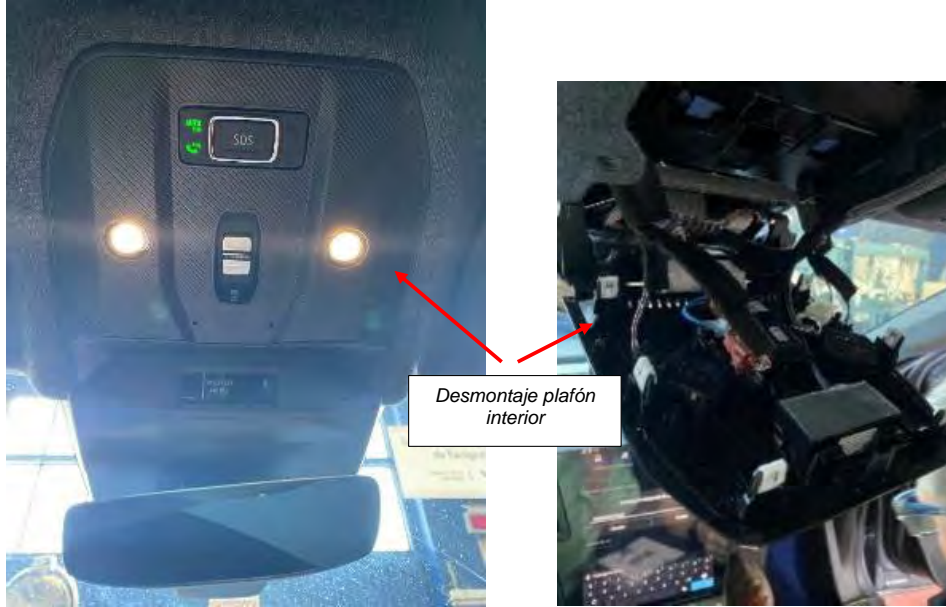
Fig. 5.5.1.4. Desenganche de las pestañas de sujeción
