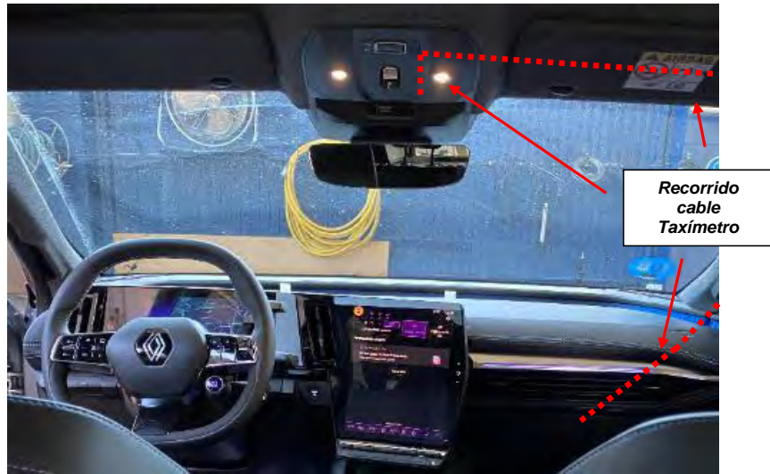
Fig. 5.3.1.6. Recorrido de los cables hasta el taxímetro de espejo.
