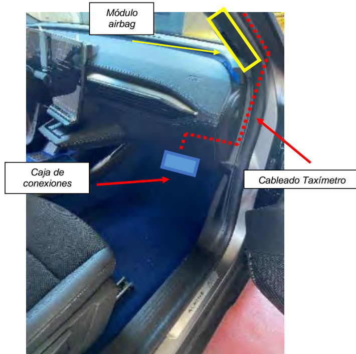
Fig. 5.3.1.8. Esquema detallado del recorrido por la parte del salpicadero
