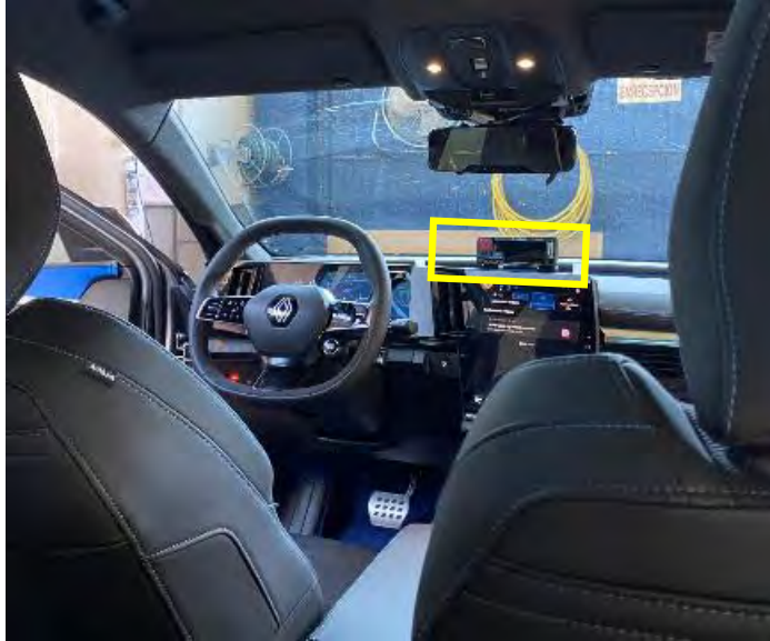
Fig. 5.3.3.2. Ubicación de taxímetro consola sobre salpicadero con pantalla
