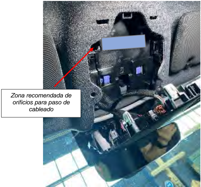
Fig. 5.5.1.5. Zona recomendada para los taladros para el módulo tarifario atornillado.
