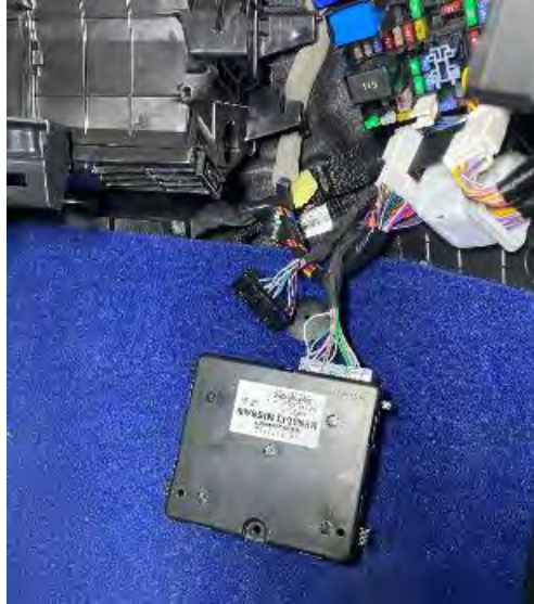
Fig. 3.4.1.11. El calculador de climatización y sus conectores.
