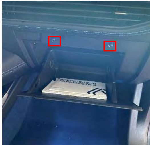
Fig. 3.4.1.4. Detalle tornillos marco interior guantera.
