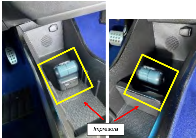
Fig. 5.4.1. Ubicación impresora en la parte inferior de la consola central.
