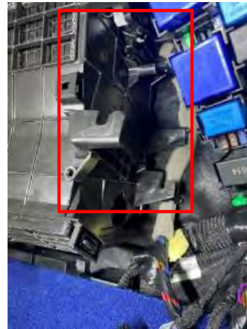
Fig. 3.4.1.10. Detalle tornillo del calculador de climatización y su ubicación.
