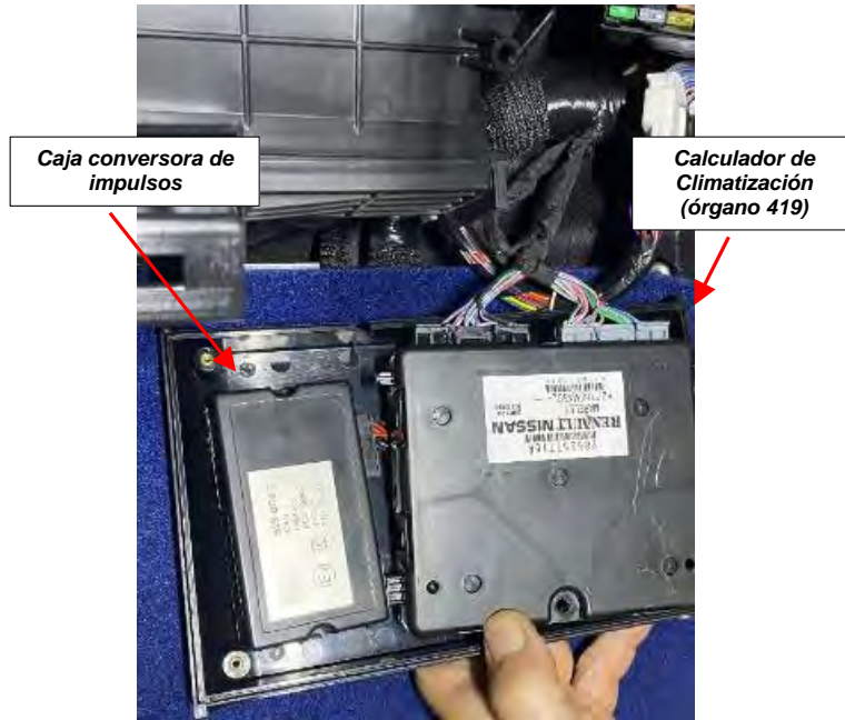
Fig. 3.4.1.2.2. Caja contenedora de calculador de Climatización (órgano 419) y caja convertora de impulsos
