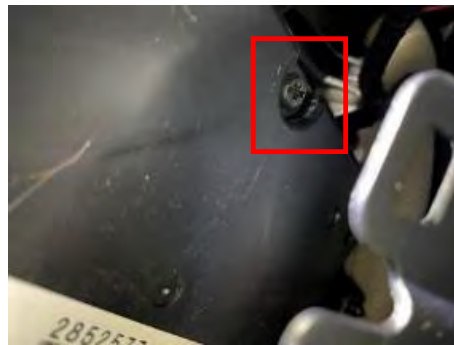
Fig. 3.4.1.10. Detalle tornillo del calculador de climatización y su ubicación.
