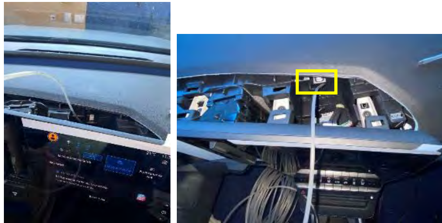
Fig. 5.3.2.5. Detalle del pasacables por la parte superior del salpicadero
