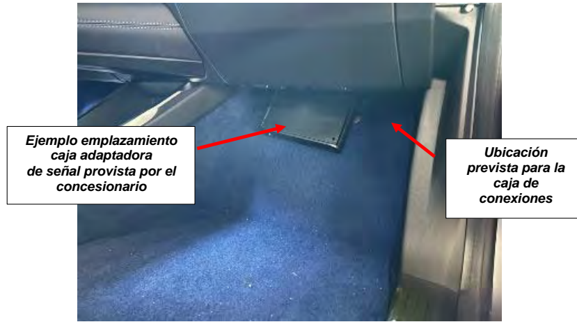
Fig. 5.2.1. Ubicación caja de conexiones a los pies del acompañante.
