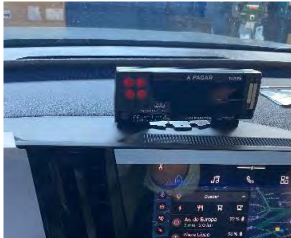
Fig. 5.3.2.2. Ubicación de taxímetro consola sobre salpicadero con pantalla
