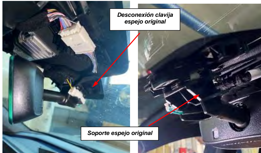
Fig. 5.3.1.3. Recorrido de los cables hasta el taxímetro de espejo.
