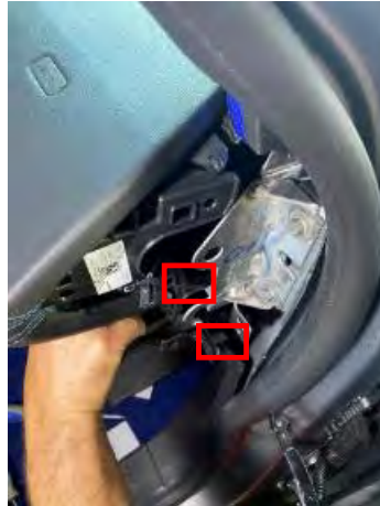
Fig. 3.4.1.7. Detalle pestañas laterales.
