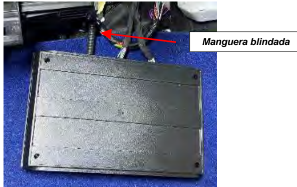
Fig. 3.4.1.2.4. Detalle caja contenedora tapada.
