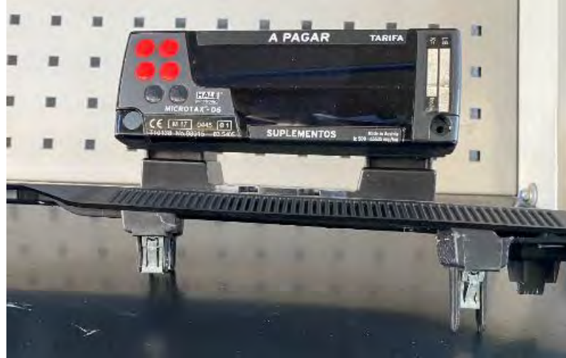
Fig. 5.3.3.4. Ubicación del taxímetro en el guarnecido plástico del salpicadero
