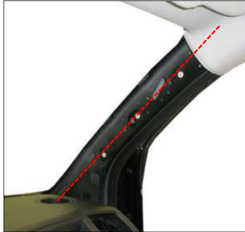
Figura 30. Recorrido del cable por montante Barcelona .
