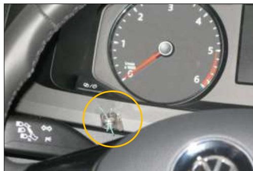
Figura 23. Precinto cuadro de instrumentos.
