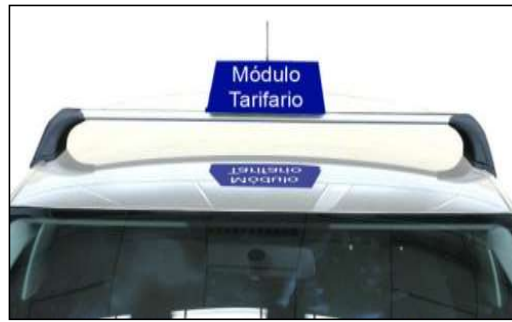
Figura 33. Emplazamiento del módulo tarifario Madrid.
