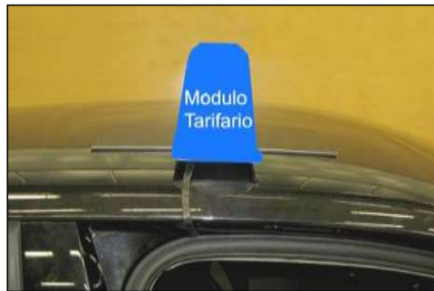
Figura 34. Emplazamiento del módulo tarifario Barcelona.
