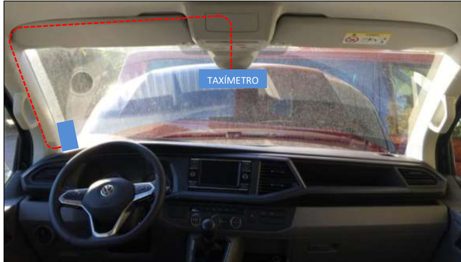
Figura 45. Recorrido cable de la impresora.
