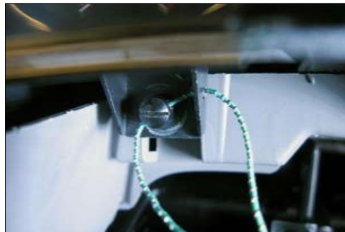
Figura 18. Detalle del precinto.
