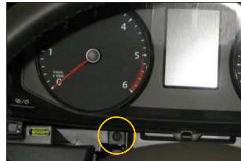
Figura 19. Tornillo a sustituir.
