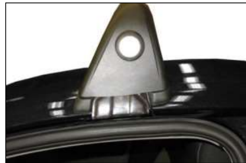
Figura 35. Emplazamiento del módulo tarifario Madrid.
