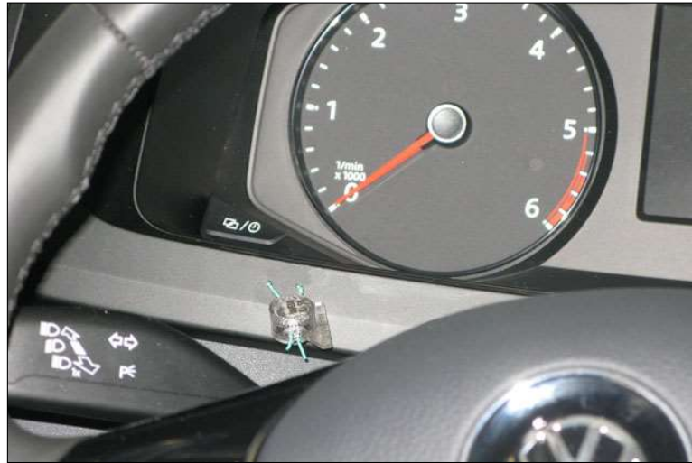
Figura 24. Precinto cuadro de instrumentos.
