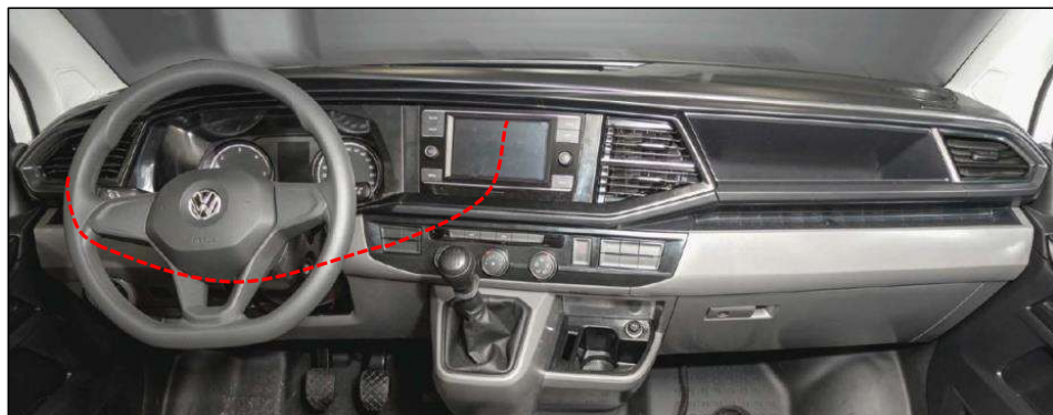
Figura 29. Trazado de la manguera para Madrid.
