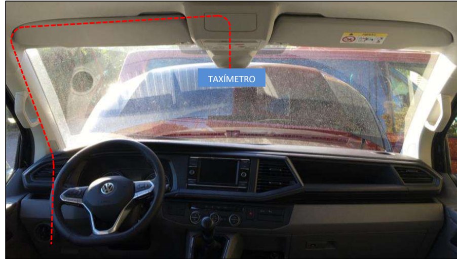
Figura 41. Recorrido de la manguera del taxímetro.
