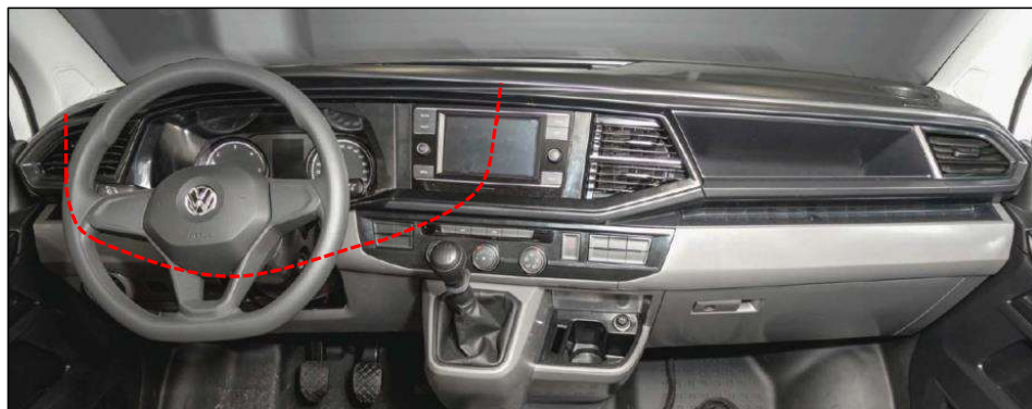
Figura 38. Recorrido cable impresora.
