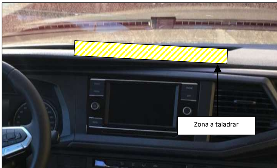
Figura 27. Zona a taladrar para el paso de mangueras.
