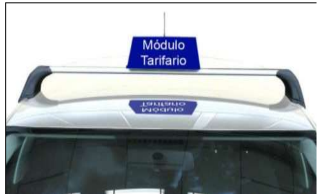
Figura 33. Emplazamiento del módulo tarifario Madrid.
