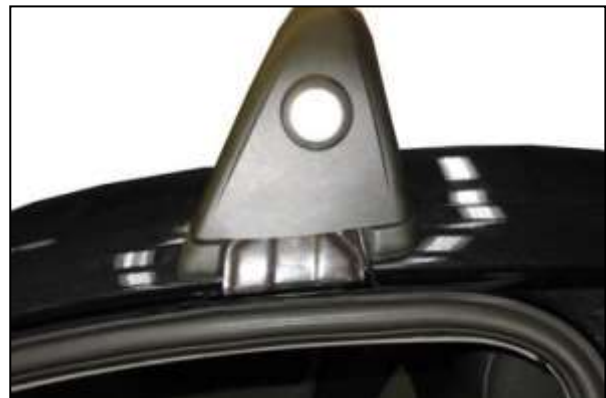
Figura 35. Emplazamiento del módulo tarifario Madrid.
