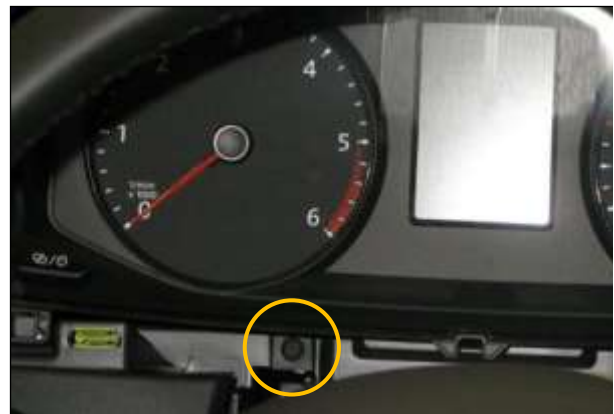
Figura 19. Tornillo a sustituir.
