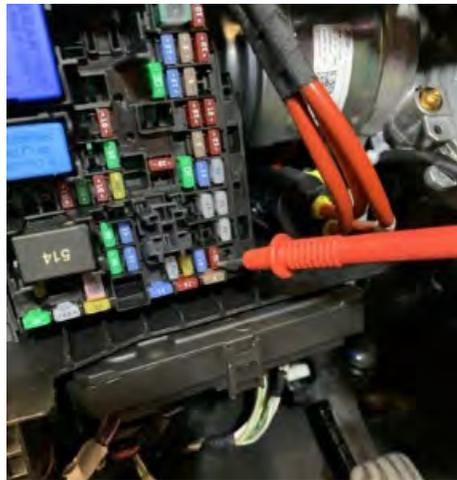
*Fig. 3.4.1.3.5. Detalle del fusible para la toma del positivo*
