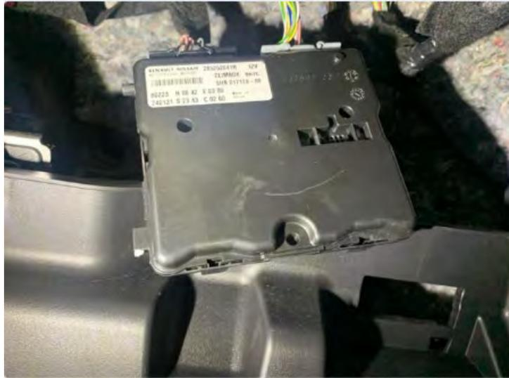
*Fig. 3.4.1.7. Calculador de climatización y conectores.*
