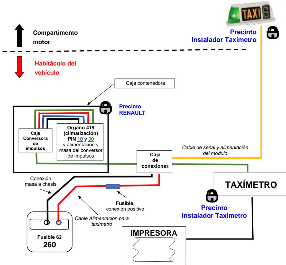
**Fusible del instalador:** La capacidad del mismo estará determinada en función del consumo previsto de los elementos a conectar aguas abajo.
