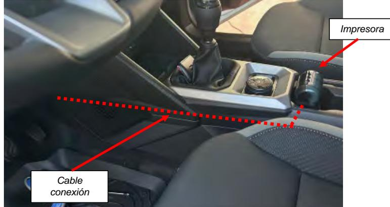
**Fig. 5.4.2.** Paso del cable por el interior de los guarnecidos plásticos.
