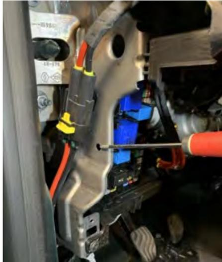
*Fig. 3.4.1.3.5. Detalle del punto de toma de masa*
