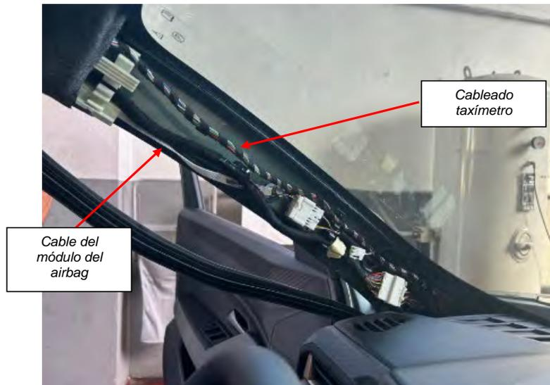
*Fig. 5.3.1.7. Detalle del recorrido del cable del taxímetro*
