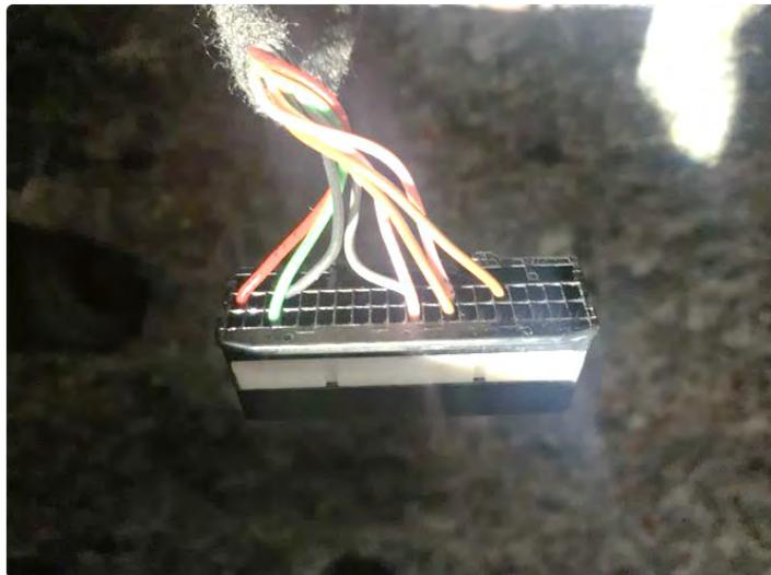
*Fig. 3.4.1.7. Conector negro del calculador de climatización desmontado.*
