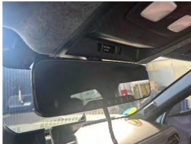
*Fig. 5.2.3. Vista del taxímetro de espejo*
