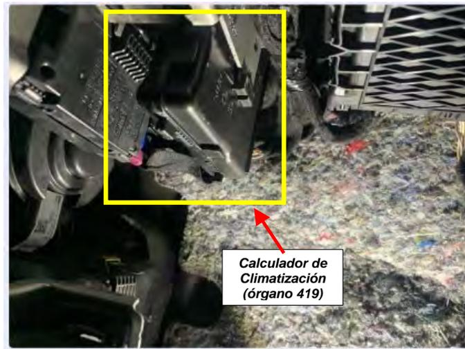
**Fig. 3.4.1.2.** Vista del calculador de Climatización (órgano 419)
