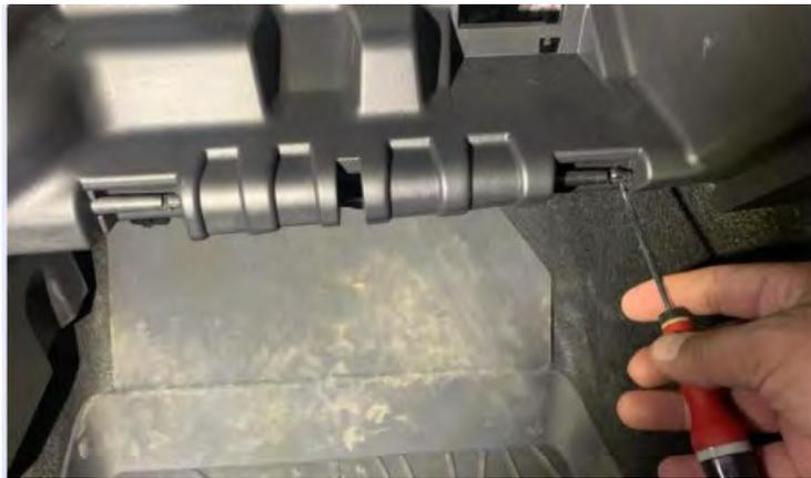
*Fig. 3.4.1.4. Vista de los pasadores (con guantera ya desmontada)*
