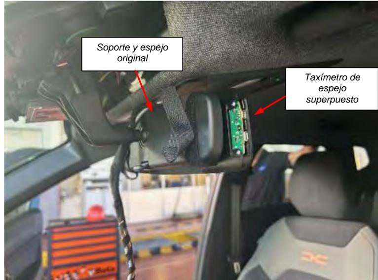
**Fig. 5.2.4.** Fijación del taxímetro de espejo superpuesto
