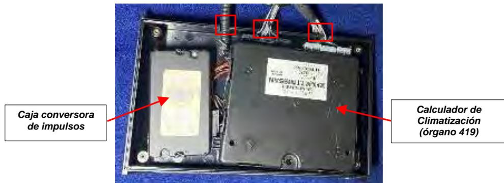
*Fig. 3.4.1.2.1. Detalle instalación en interior de la caja contenedora*
