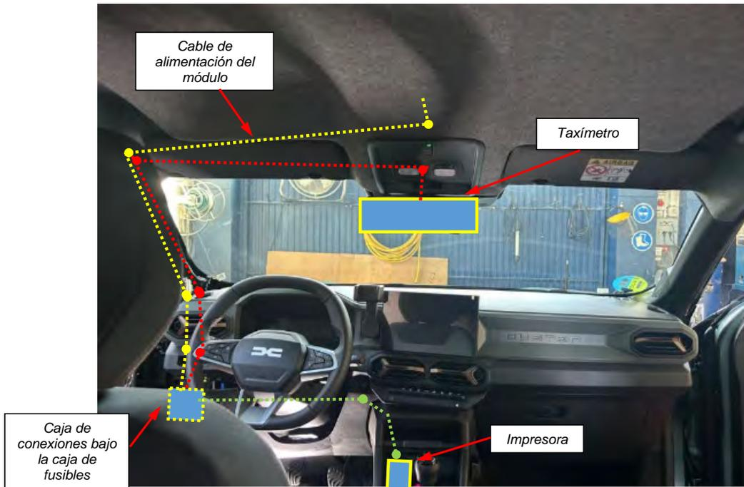
**Fig. 5.2.1.** Esquema orientativo de las conexiones.
