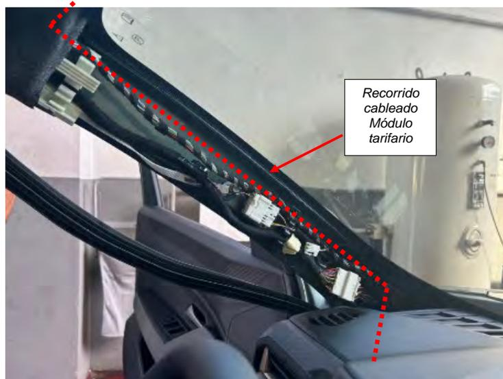
*Fig. 5.4.1.8. Recorrido del cable del módulo por el interior del pilar del parabrisas.*
