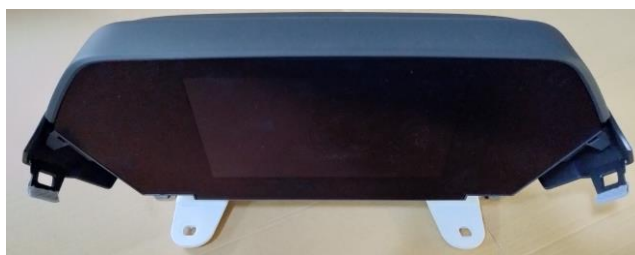
Vista general cuadro de instrumentos con sus cubiertas
