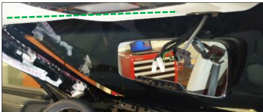
Recorrido del cable del módulo tarifario
