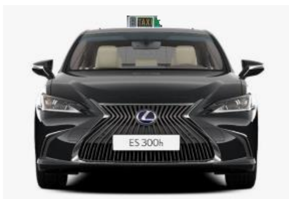
Ubicación módulo tarifario exterior fijo
