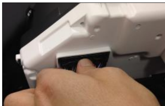
2. Presionar lengüeta superior del conector
