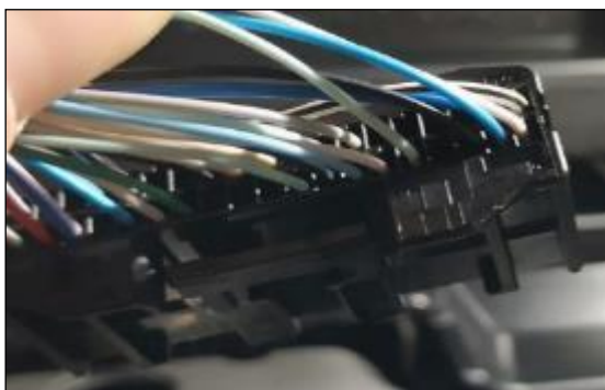
4. Soldar cable taxímetro a la señal de velocidad
