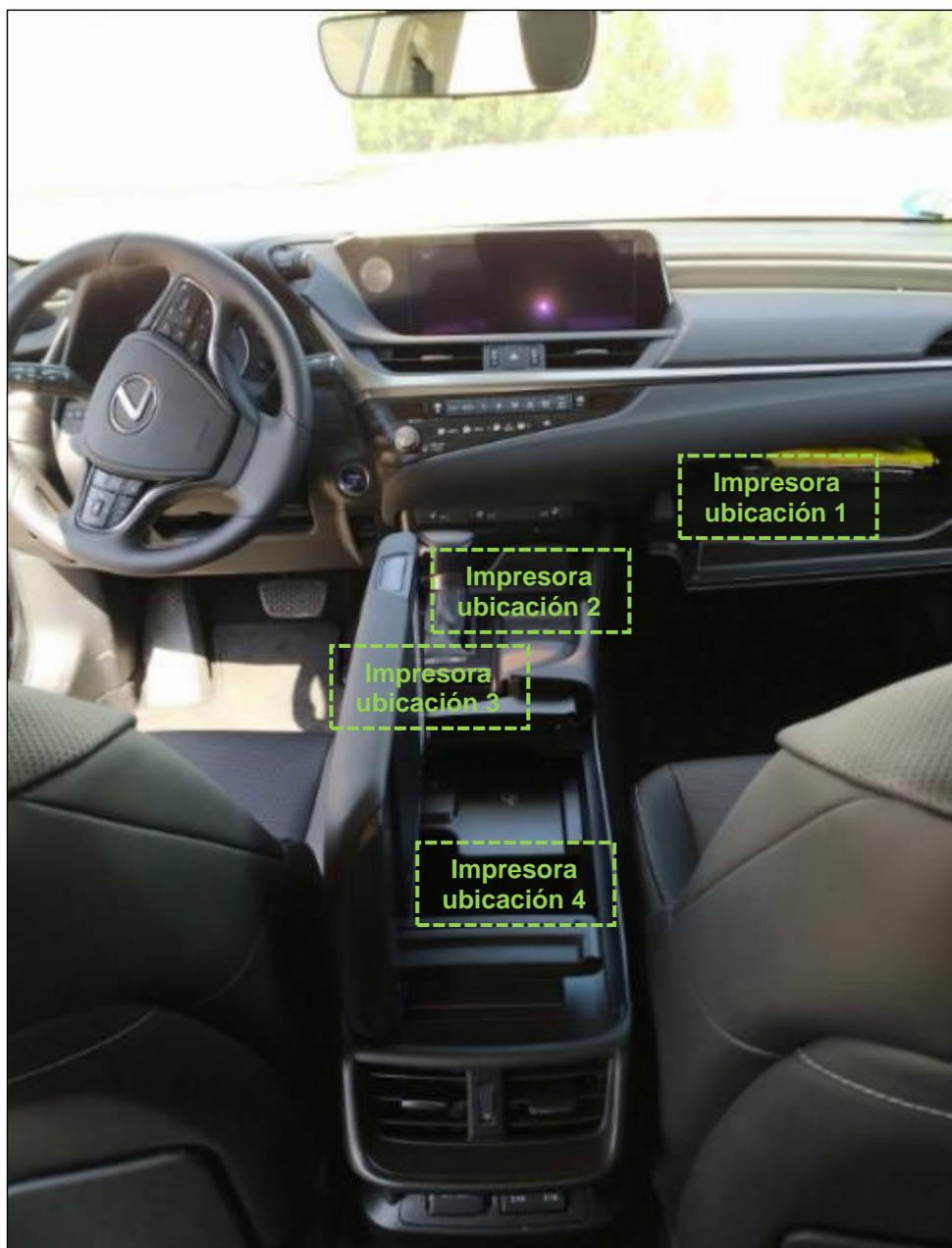
En cualquiera de estas ubicaciones, los cables de conexión necesarios para la impresora se llevarán por el interior de los guarnecidos, desde el punto de origen (caja de conexiones o conector cuadro de instrumentos) hasta dicha impresora.
