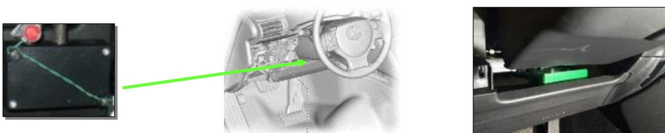
**Nota importante:** La ubicación indicada es la más idónea en base a la facilidad de acceso / inspección. No obstante, el instalador autorizado podrá reubicar la caja de conexiones en el área bajo el panel de instrumentos bien en la zona izquierda, o tras la guantera del lado derecho si por razones de cableados o conexiones no fuera posible instalarla bajo el volante, y siempre que no interfiera en los sistemas del vehículo (airbag, dirección, calefacción).
