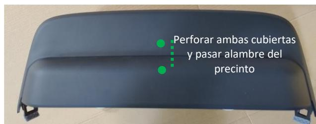
Vista superior del cuadro de instrumentos con sus cubiertas
