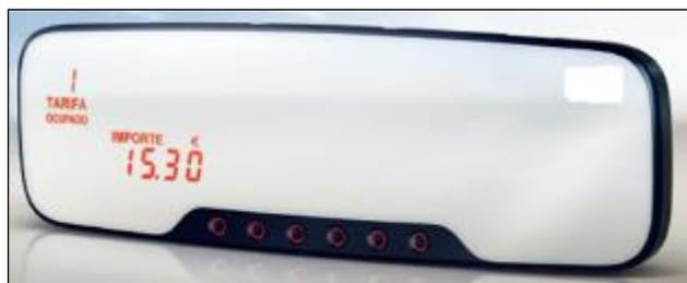
*Taxímetros de espejo sustitutos del espejo retrovisor interior original del vehículo deben disponer y ser compatibles con impresoras periféricas.*
