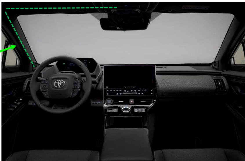
Dado que en este vehículo solamente se admiten como taxímetros los modelos que están ubicados en el espejo retrovisor interior, los cableados necesarios irán por el lado izquierdo del guarnecido del techo desde el plafón de luces y bajarán por el pilar "A" del lado del conductor hasta el cuadro de instrumentos / caja de conexiones bajo volante y demás elementos. En función del tipo de instalación, podría hacerse también por el lado derecho.
