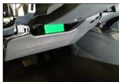
**Nota importante:** La ubicación indicada es la más idónea en base a la facilidad de acceso / inspección. No obstante, el instalador autorizado podrá reubicar la caja de conexiones en el área bajo el panel de instrumentos de la zona izquierda, siempre que no interfiera en los sistemas del vehículo (airbag, dirección, calefacción).
