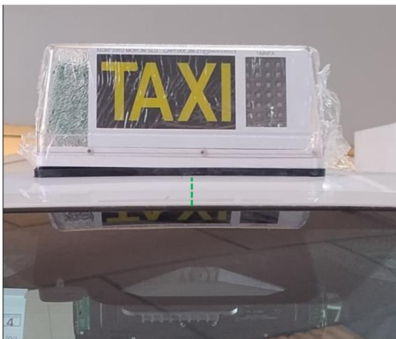
1. Desmontar el conjunto del plafón de luces del techo.
