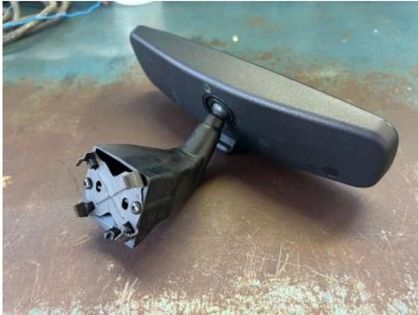
Fig. 5.2.2. Vista del retrovisor original y su soporte desmontado
