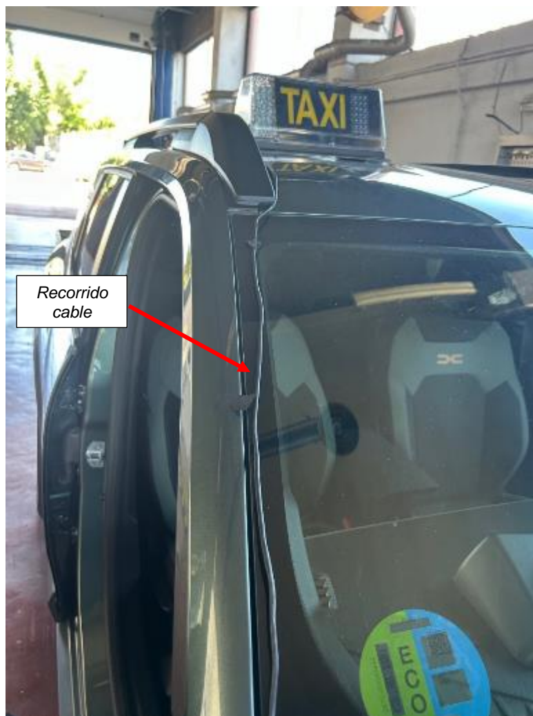
Fig. 5.4.2.2. Recorrido del cable del módulo por el vierte aguas del parabrisas
