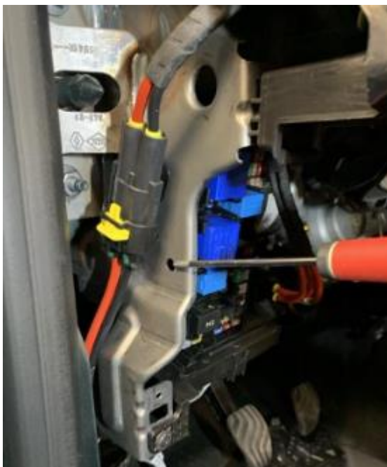
Fig. 3.4.1.3.5. Detalle del punto de toma de masa
