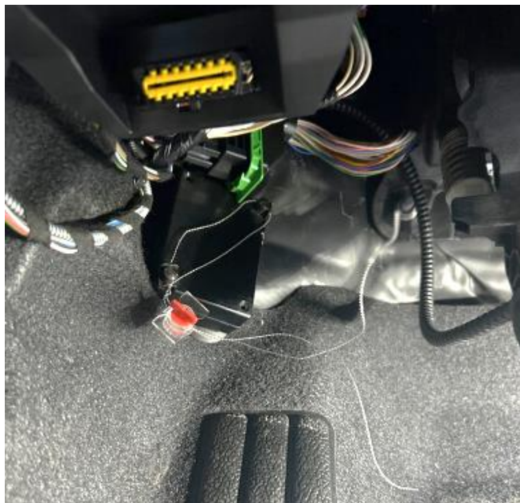
Fig. 4.1.1. Vista de la ubicación de la caja de conexiones una vez precintada
