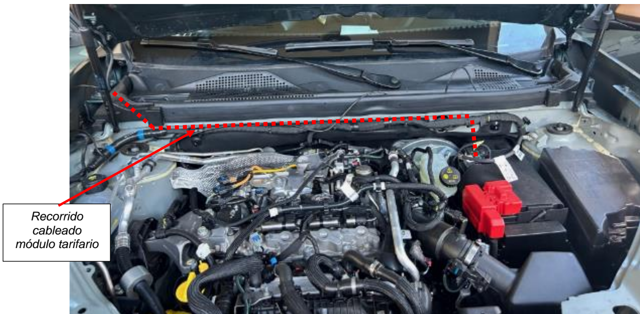
Fig. 5.4.2.4. Recorrido del cable del módulo por el compartimento motor
