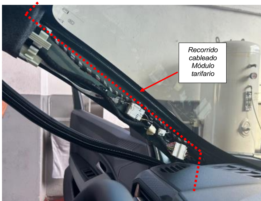
Fig. 5.4.1.8. Recorrido del cable del módulo por el interior del pilar del parabrisas.
