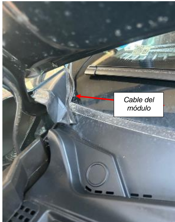
Fig. 5.4.2.3. Vista del paso del cable del módulo al compartimento motor
