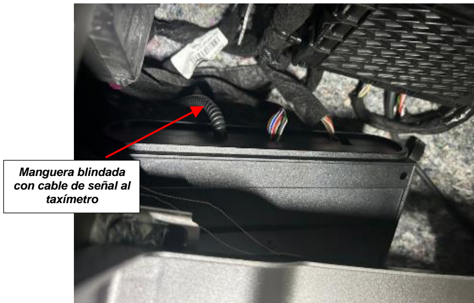
Fig. 3.4.1.2.3. Posicionamiento de la caja en interior del habitáculo tras la guantera
