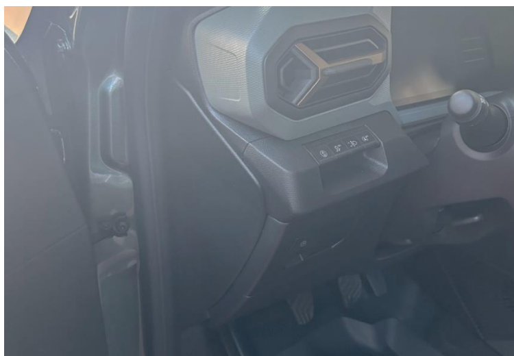
Fig. 3.4.1.3.1. Ubicación de la caja de fusibles
