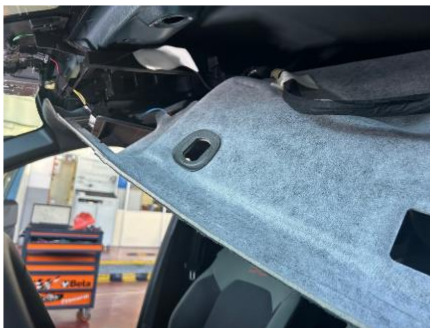
Fig. 5.4.1.5. Vista del interior del guarnecido del techo.
