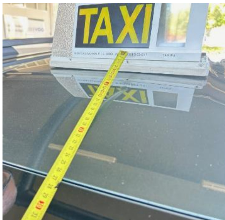
Fig. 5.4.1.3. Distancia de separación al parabrisas.
