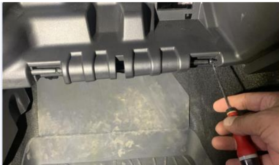
Fig. 3.4.1.4. Vista de los pasadores (con guantera ya desmontada)
