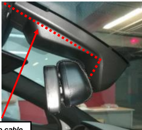
Recorrido cable Taxímetro
