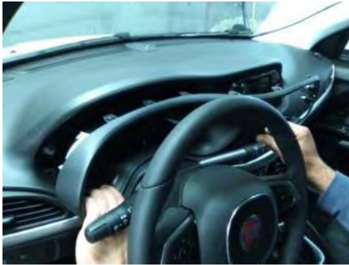
Quitar los tornillos de fijación del cuadro del navegador/radio (1a)
