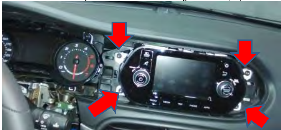
Quitar los tornillos de fijación del cuadro del navegador/radio (1a)
